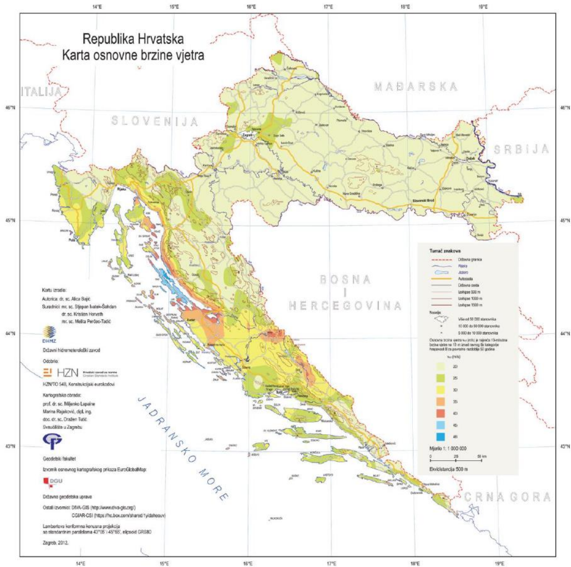
Slika 9 Karta osnovnih brzina vjetra v_{b,o}
