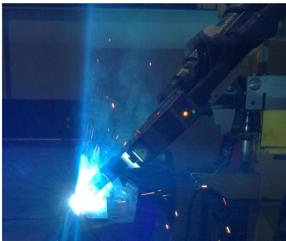
Slika 21. Zavarivanje uzoraka
