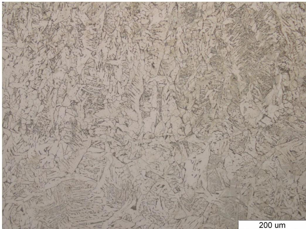
Slika 34 . Mikrostruktura korijena zavara pri povećanju 200 x - Uzorak 2
