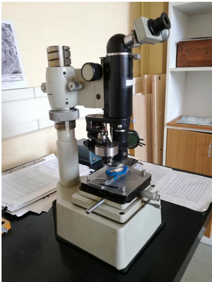
Slika 37. Mjerni uređaj za ispitivanje tvrdoće metodom Vickers
