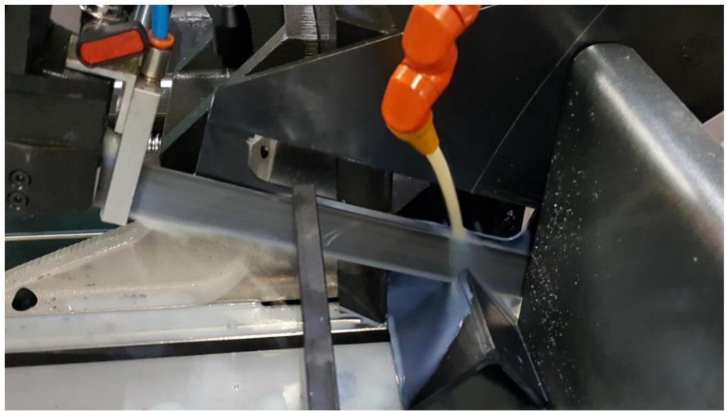
Slika 22. Rezanje zavarenih uzoraka
