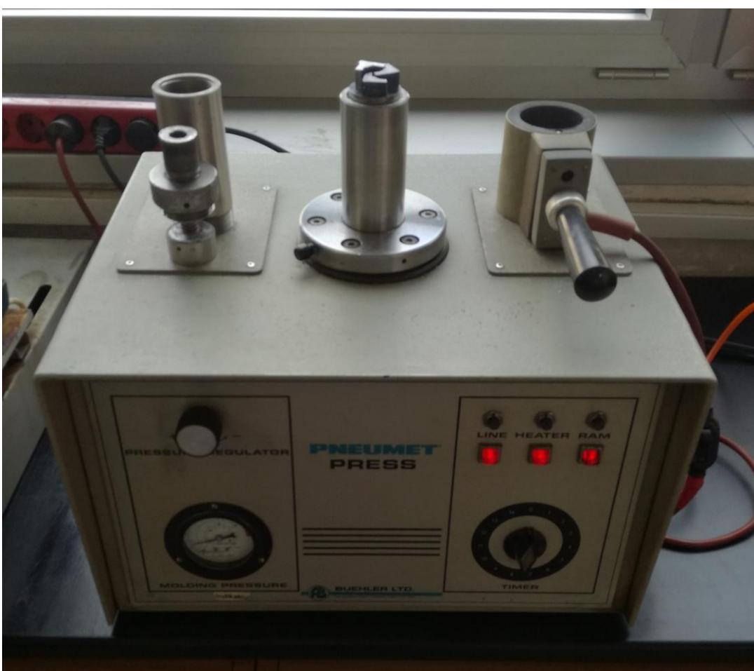
Slika 24. Buehler Pneumet press
