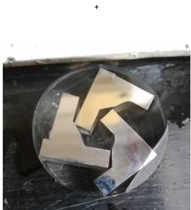
Slika 29. Uzorci nakon poliranja
