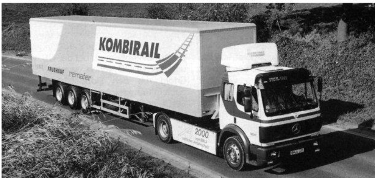
Slika 12. Primjer bimodalne tehnologije
