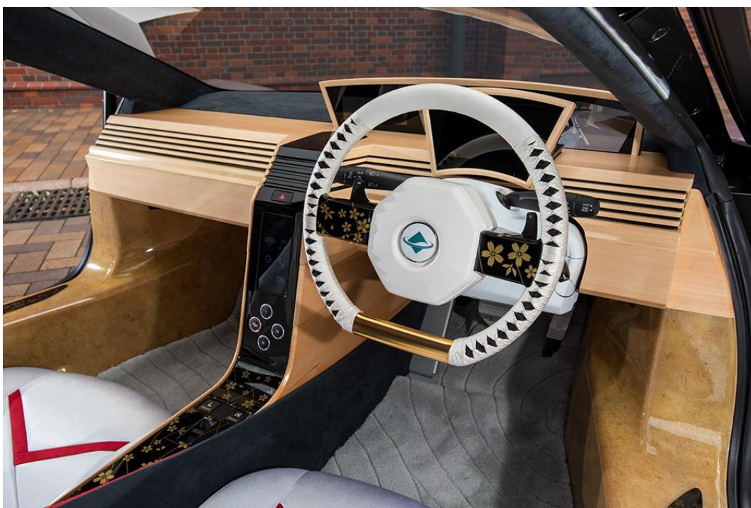
Slika 18. Automobil od nanofibre celuloze
