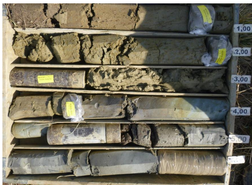
Slika 2.2. Prikaz rezultata geoistražnog bušenja
