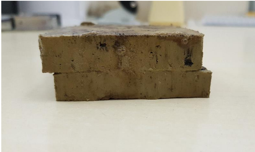
Slika 3.12. Prikaz uzorka ispitanog na posmik
