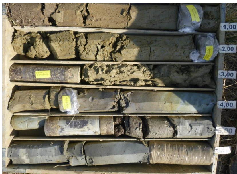
Slika 2.2. Prikaz rezultata geoistražnog bušenja
