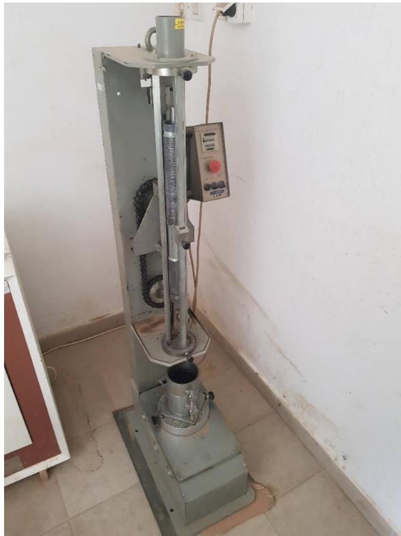
Slika 3.5. Laboratorijska aparatura za Proctor-ov pokus
