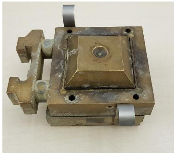
Slika 3.11. Prikaz ćelije izravnog posmika sa ugrađenim uzorkom
