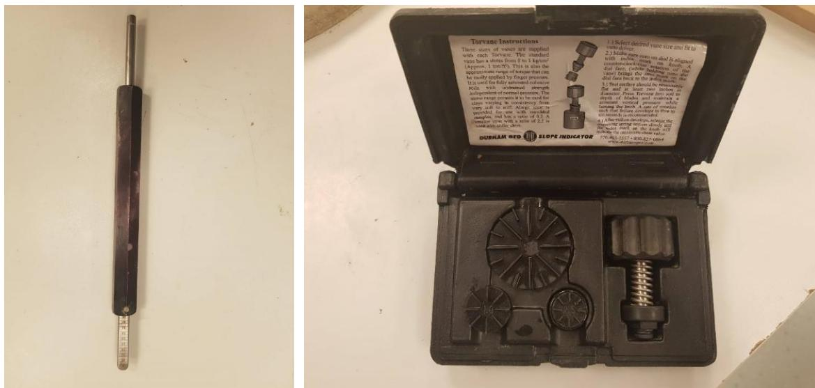
Slika 2.4. Džepni penetrometar i džepna krilna sonda
