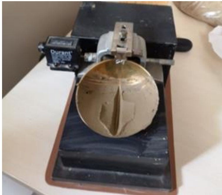
Slika 3.1. Casagrandeov uređaj sa ispitnim uzorkom
