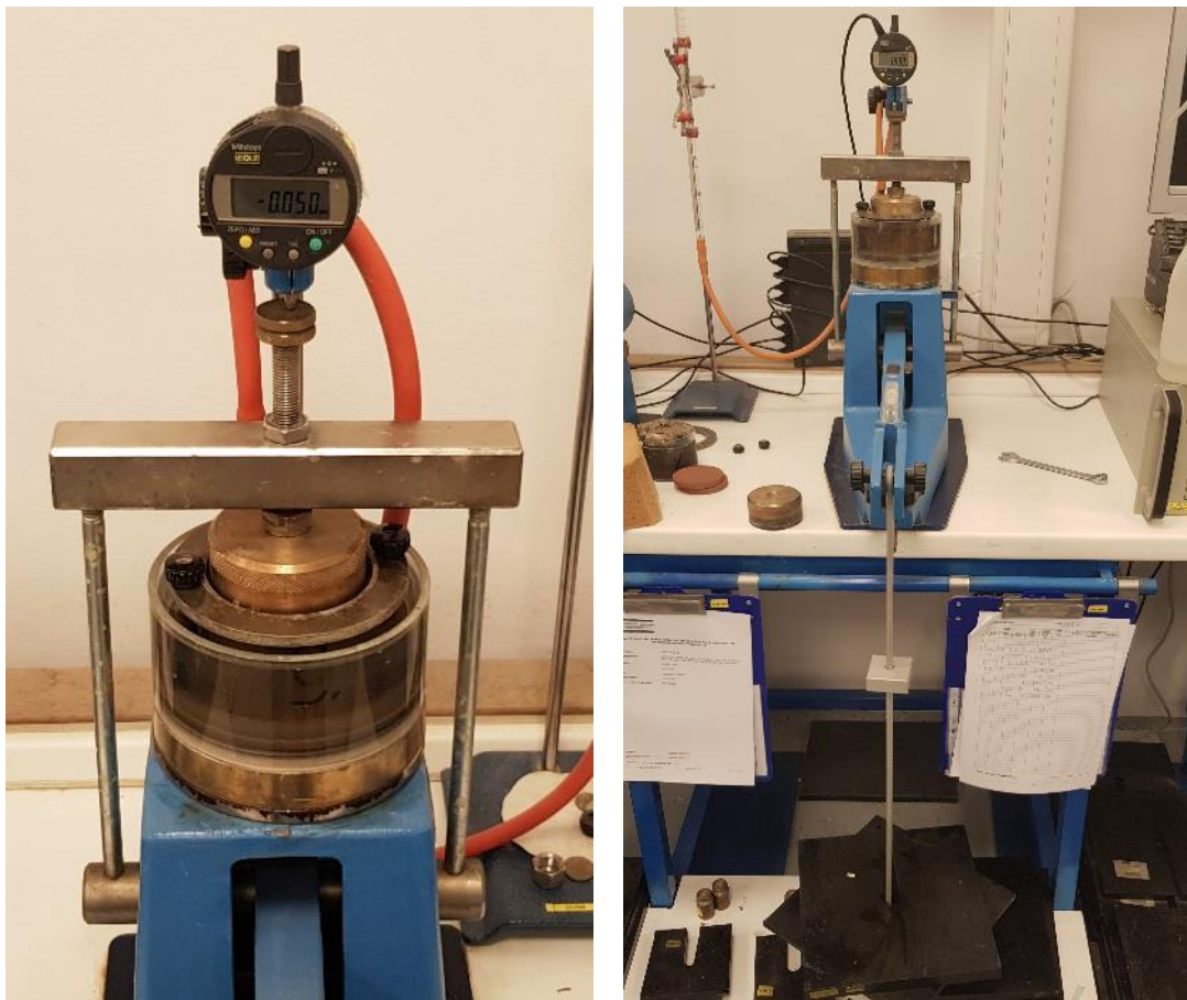
Slika 3.13. Edometar sa ugrađenim uzorkom u ćeliji za ispitivanje.
