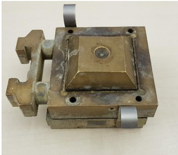
Slika 3.11. Prikaz ćelije izravnog posmika sa ugrađenim uzorkom
