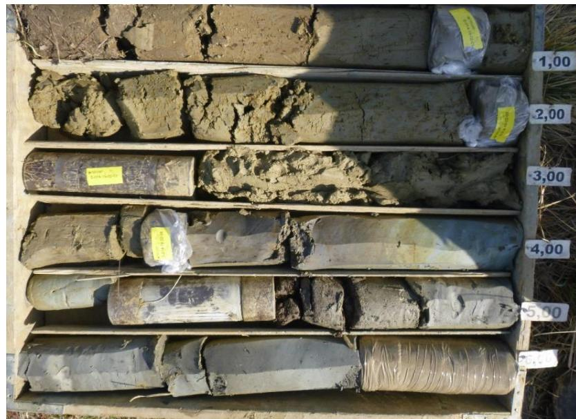
Slika 2.2. Prikaz rezultata geoistražnog bušenja
