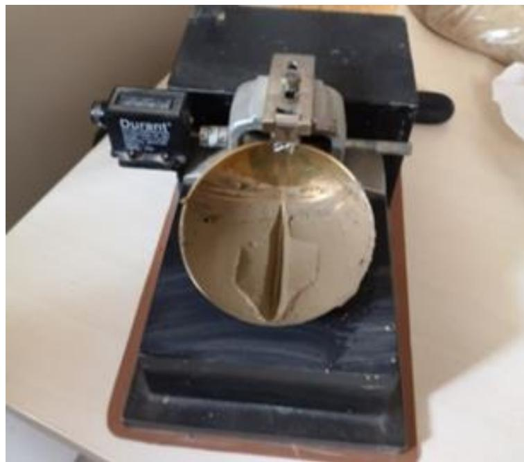
Slika 3.1. Casagrandeov uređaj sa ispitnim uzorkom
