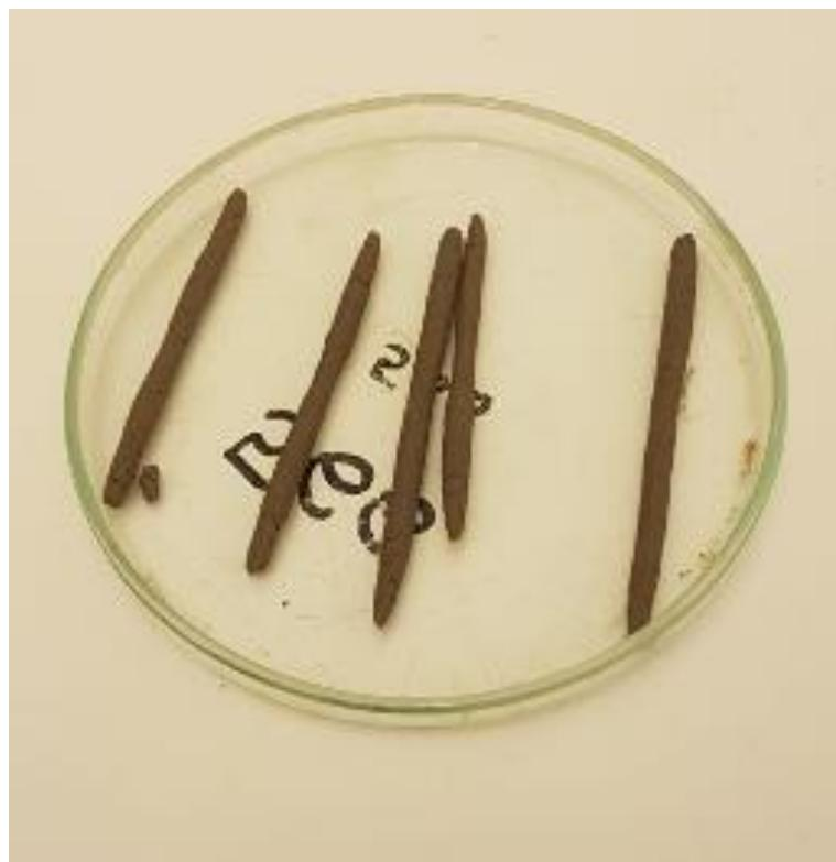
Slika 3.3. Pripremljeni uzorci valjčića kod ispitivanje granica plastičnosti
