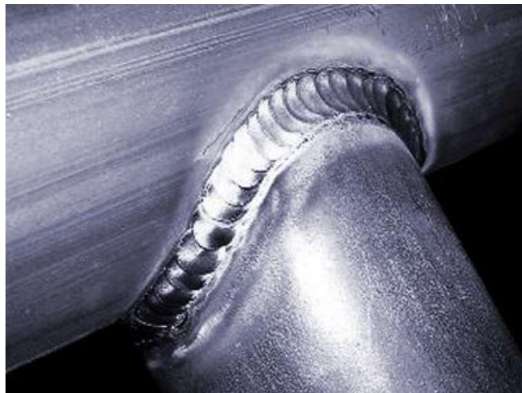
Slika 18. Zavar cijevi TIG metodom zavarivanja [21]
