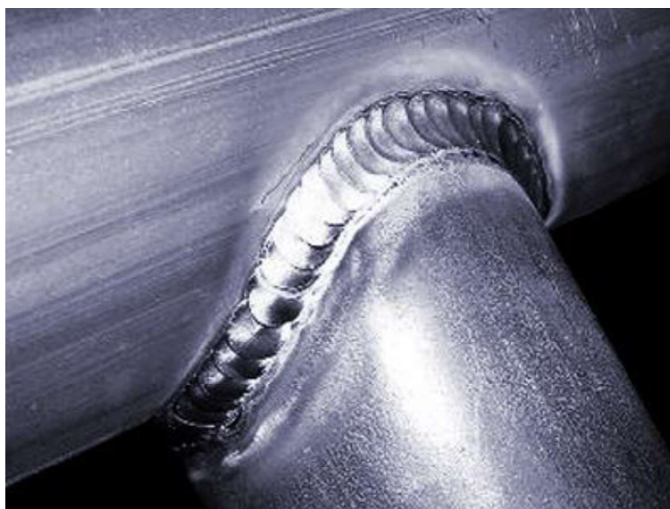
Slika 18. Zavar cijevi TIG metodom zavarivanja [21]
