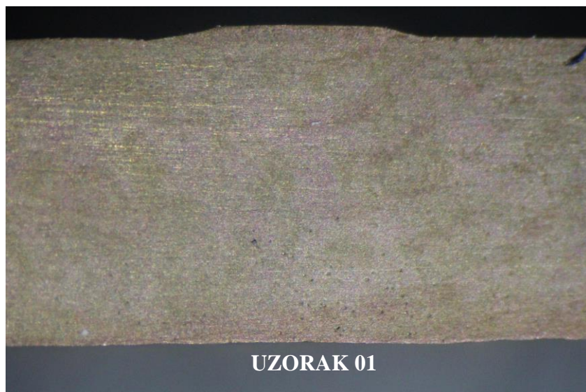
Slika 58. Poprečni presjek zavarenog spoja uzorka 01
