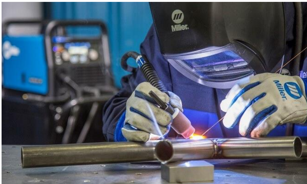
Slika 27. Primjer ručnog TIG zavarivanja [36]
