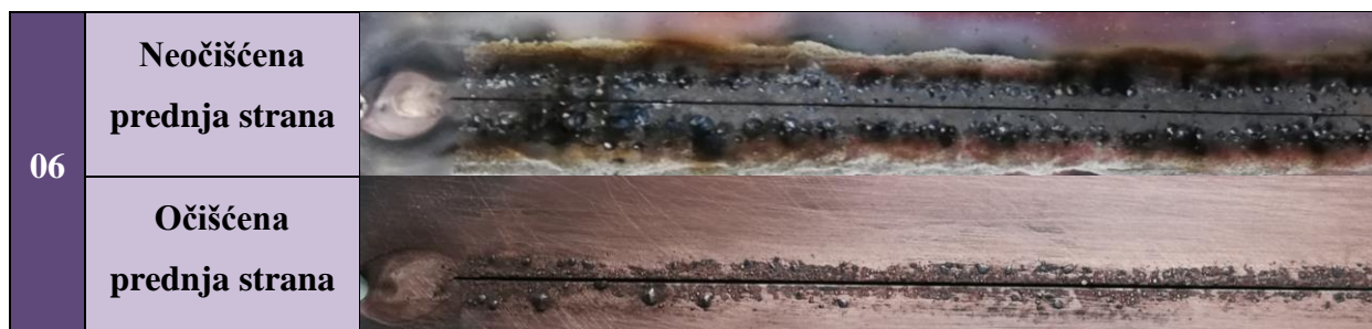
Slika 57. Prikaz nanešenih aktivacijskih premaza prije zavarivanja
