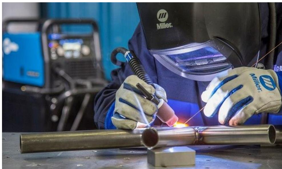
Slika 27. Primjer ručnog TIG zavarivanja [36]
