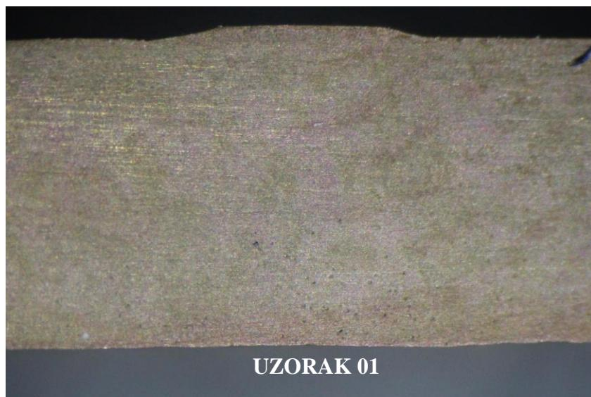
Slika 58. Poprečni presjek zavarenog spoja uzorka 01
