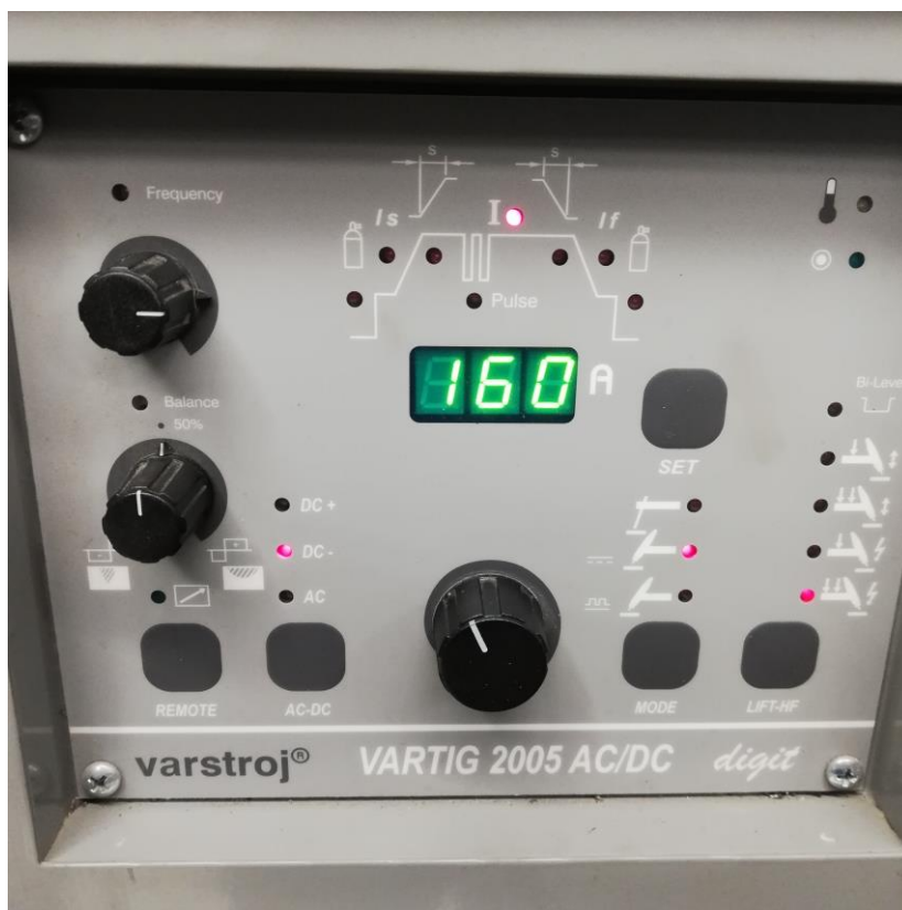
Slika 50. Upravljačka ploča sa digitalnim prikazom jakosti struje
