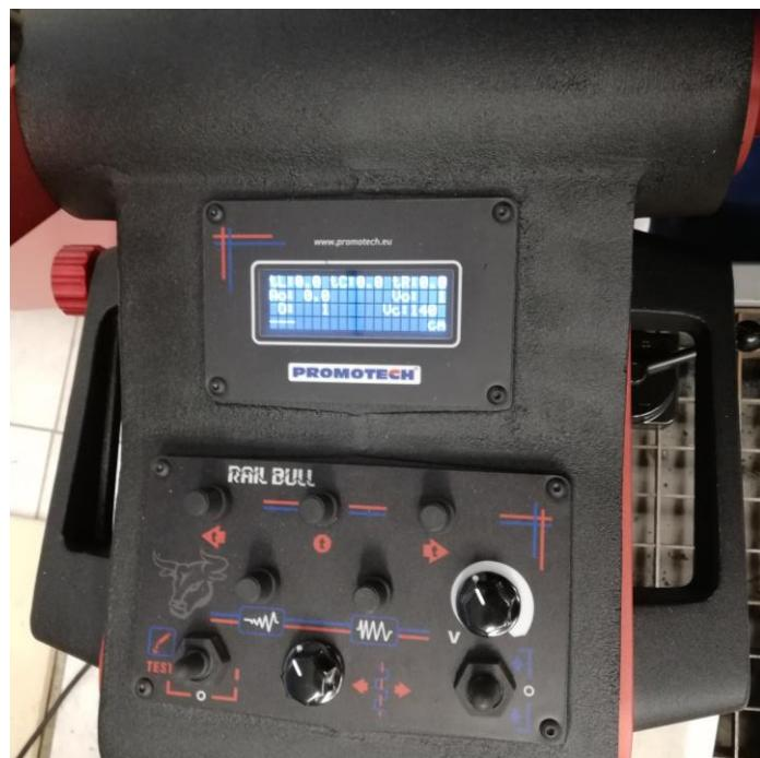
Slika 51. Kontrolna ploča uređaja za automatsko zavarivanje
