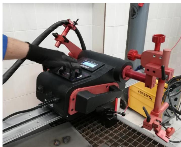
Slika 52. RAIL BULL uređaj za automatizacijsko zavarivanje
