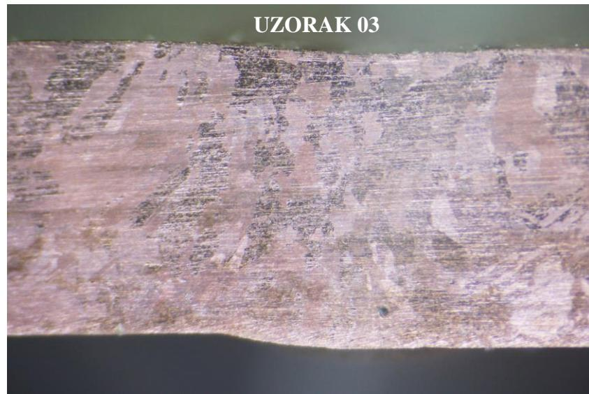
*Slika 59. Poprečni presjek zavarenog spoja uzorka 03*
