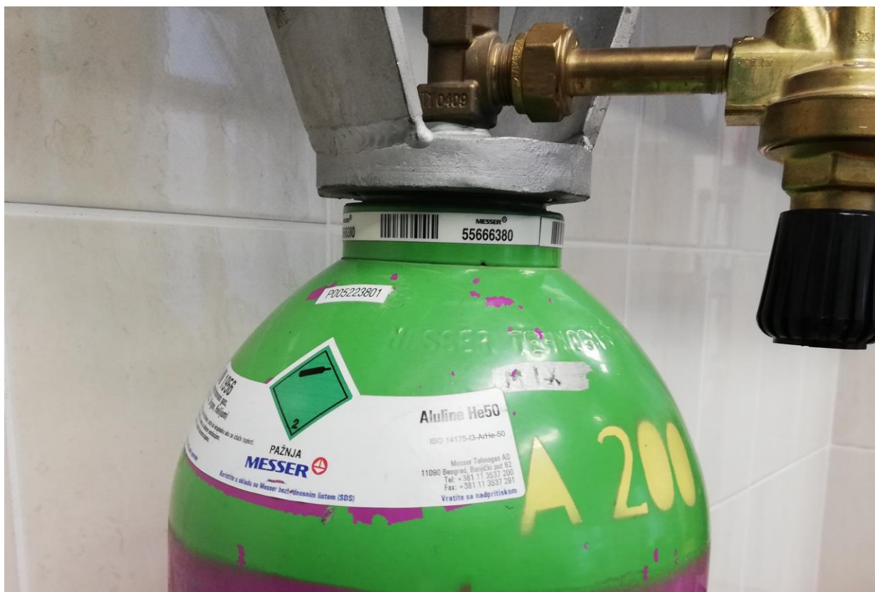
Slika 49. Boca zaštitnog plina Aluline He50 Messer
