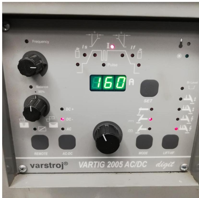
Slika 50. Upravljačka ploča sa digitalnim prikazom jakosti struje
