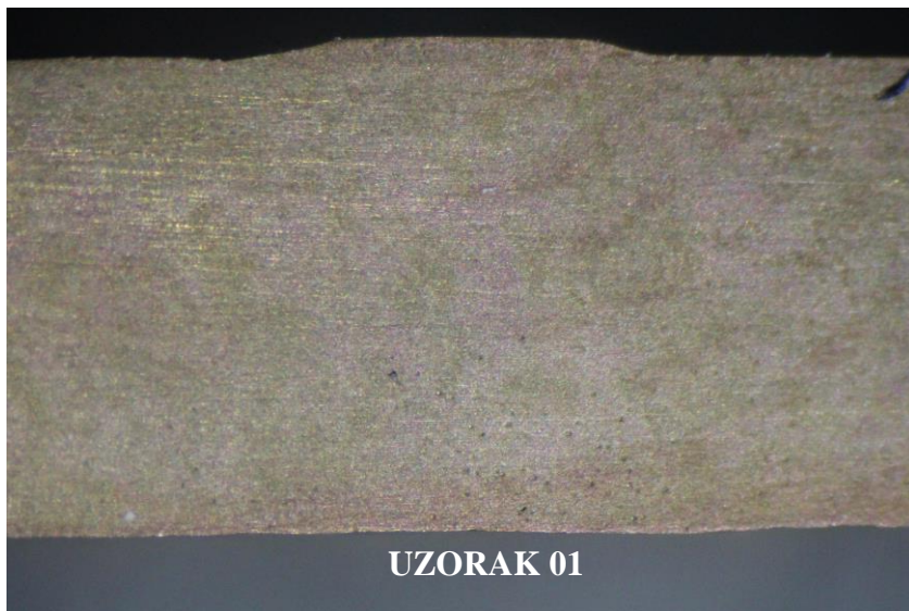
Slika 58. Poprečni presjek zavarenog spoja uzorka 01
