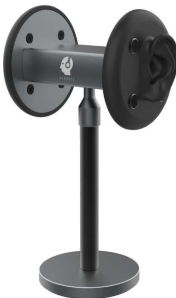
Slika 2.9: Mikrofon korišten za snimanje binauralnom tehnikom
