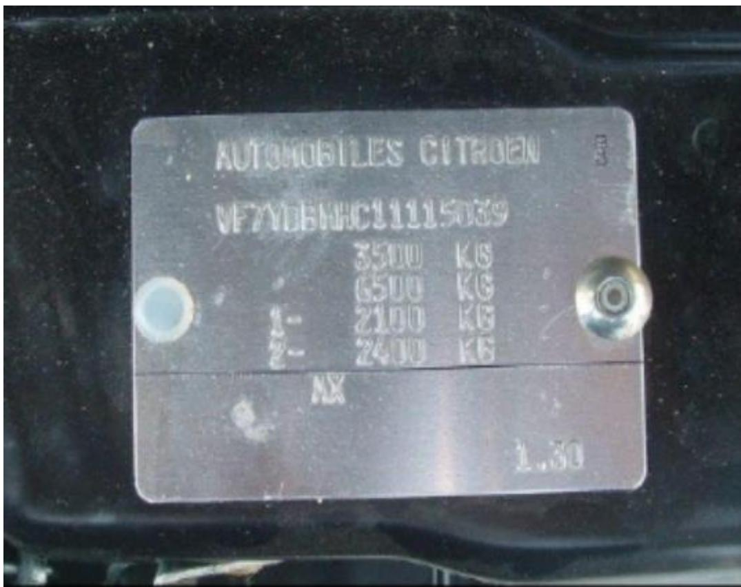
Slika 9: Identifikacijska pločica vozila
