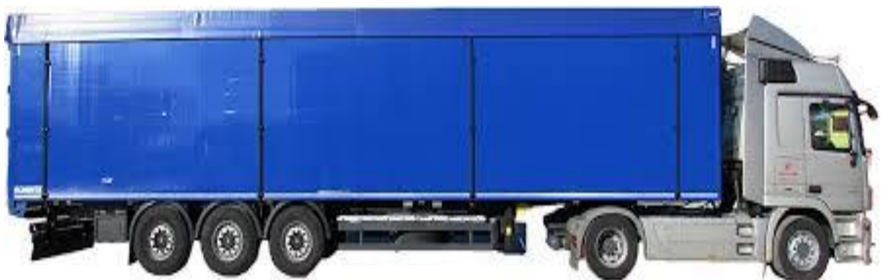
Slika 7: tegljač s dvije osovine i poluprikolica s tri osovine
