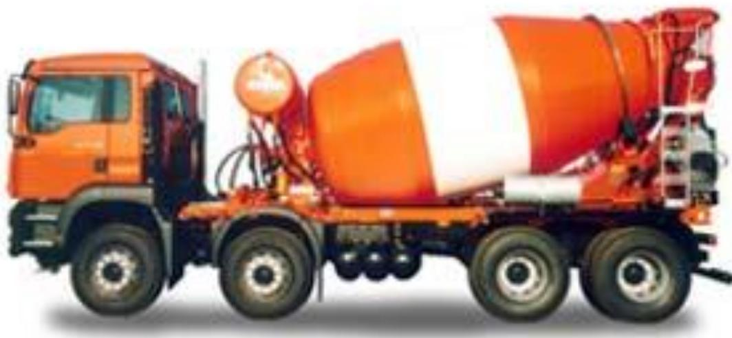
*Slika 4: automješalica za prijevoz betona*
