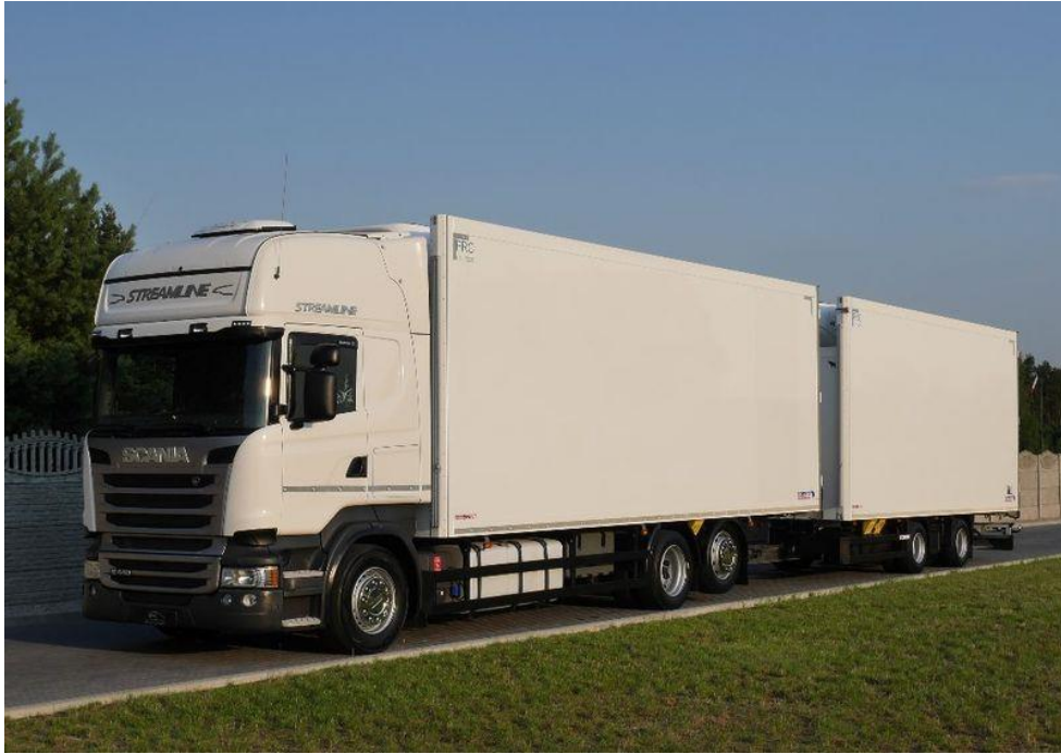
Slika 6: Kamion s 3 osovine i prikolica s 2 osovine
