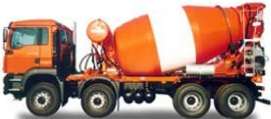
Slika 4: automješalica za prijevoz betona
