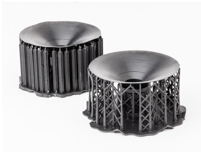
Slika 3. 3D ispis objekta s potporama [5]
