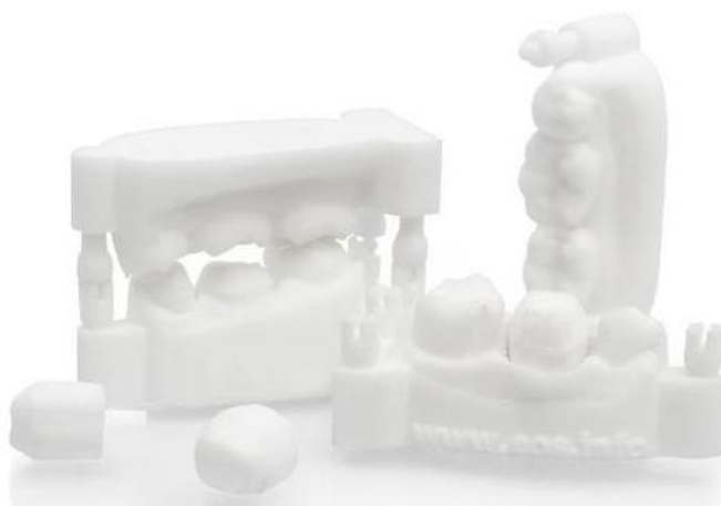
Slika 8. Objekt ispisan SLS tehnologijom (dentalni model) [9]
