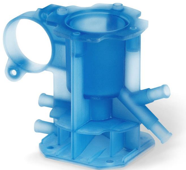
Slika 10. Objekt ispisan SLA tehnologijom [10]
