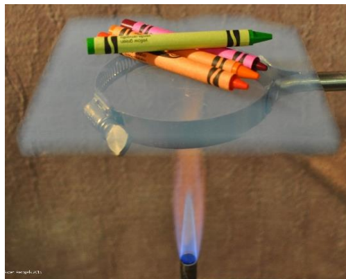
Slika 5.1.4. Toplinski otpor uzorka aerogela
