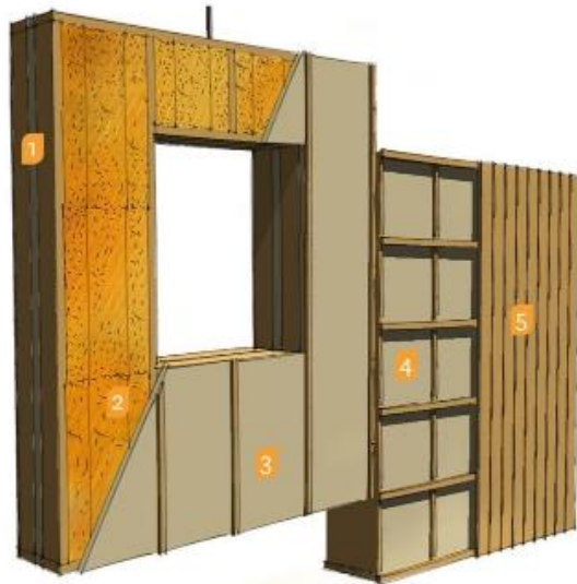
Slika 1.5. Slojevi ovojnice na bazi slame
