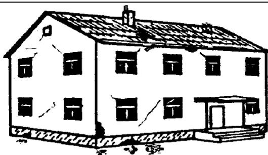
**RAZRED 2.: Umjerena oštećenja (lagana strukturna oštećenja, umjerena nestrukturna oštećenja)**
