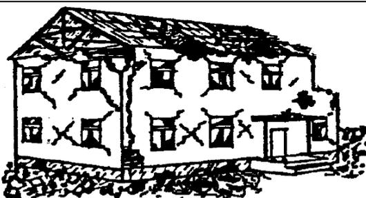
**RAZRED 4.: Vrlo velika oštećenja (velika strukturna oštećenja, vrlo velika nestrukturna oštećenja).**
