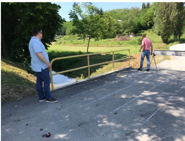
Slika br.4.2. Priprema za ispitivanje metodom Impact-Echa
