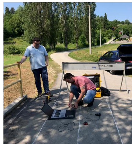
Slika br.4.2. Priprema za ispitivanje metodom Impact-Echa
