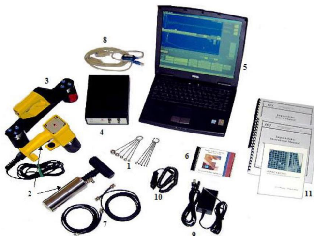
Slika 2.9. Prior za ispitivanje Impact – Echa [6]
