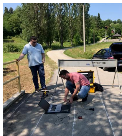
Slika br.4.2. Priprema za ispitivanje metodom Impact-Echa
