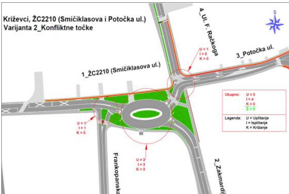
Slika 14. Analiza konfliktnih točaka Varijante 2. na raskrižju ŽC2210 (Smičiklasova i Potočka ul.) i nerazvrstane ceste (Ul. F. Račkoga i Zakmardijeva ul.) [1]
