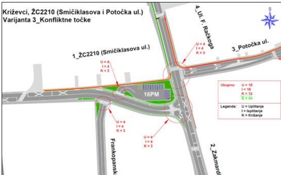
Slika 17. Analiza konfliktnih točaka Varijante 3. na raskrižju ŽC2210 (Smičiklasova i Potočka ul.) i nerazvrstane ceste (Ul. F. Račkoga i Zakmardijeva ul.) [1]
