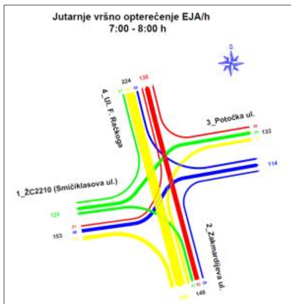
Grafikon 5. Podjela prometnih tokova po smjerovima kretanja za raskrižje ŽC2210 (Smičiklasova i Potočka ul.) i nerazvrstane ceste (Ul. F. Račkoga i Zakmardijeva ul.) u jutarnjem vršnom opterećenju [1]
