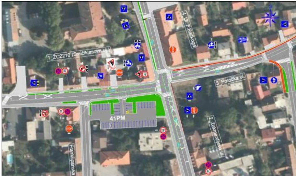
Slika 12. Trajektorije mjerodavnog vozila – postojeće stanje.[1]
