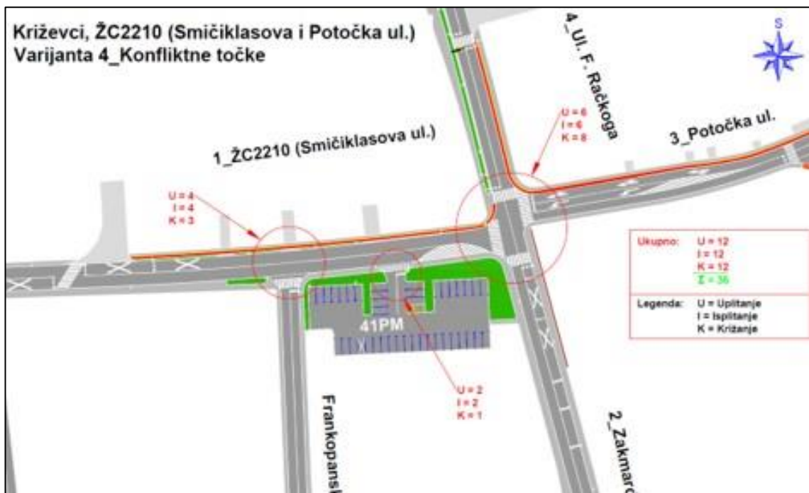
Slika 20. Analiza konfliktnih točaka Varijante 4. na raskrižju ŽC2210 (Smičiklasova i Potočka ul.) i nerazvrstane ceste (Ul. F. Račkoga i Zakmardijeva ul.)[1]
