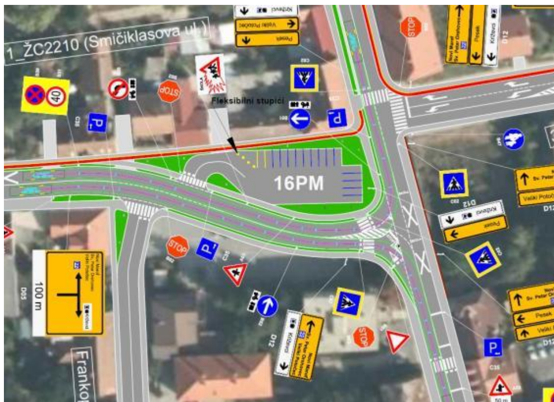
Slika 19. Trajektorije mjerodavnog vozila za varijantno rješenje 3.[1]
