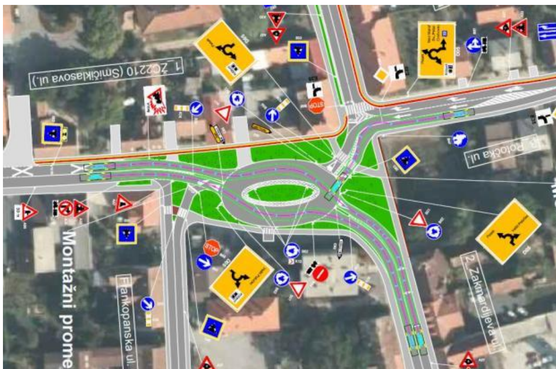
Slika 16. Trajektorije mjerodavnog vozila za varijantno rješenje 2.[1]
