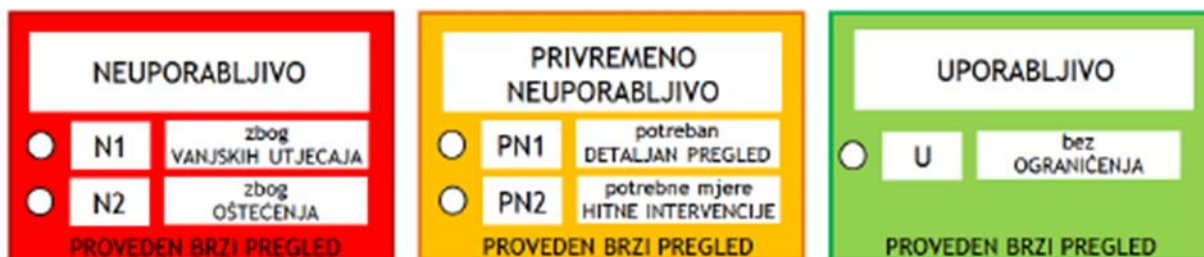
Slika 3.10. Razine oštećenja koje su utvrđivane brzim pregledima
