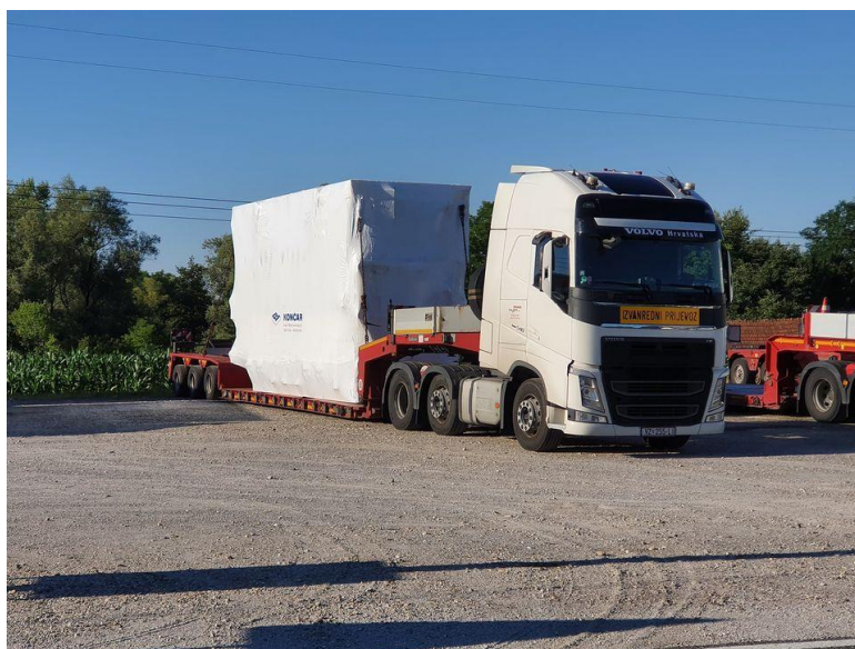
Slika 30. Izvanredni prijevoz transformatorskog kotla (Končar)
