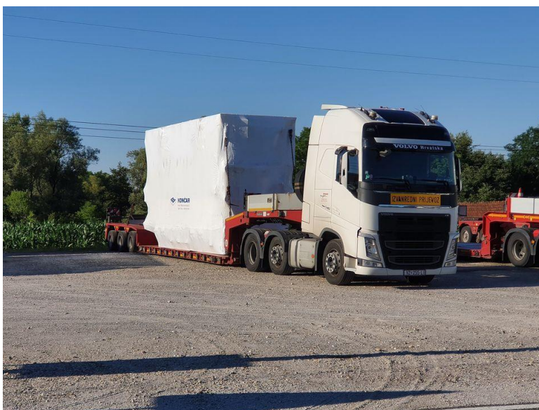
Slika 30. Izvanredni prijevoz transformatorskog kotla (Končar)
