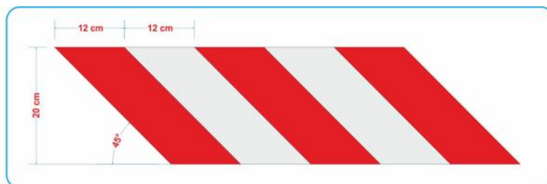
Slika 18. Crveno bijela reflektirajuća traka
