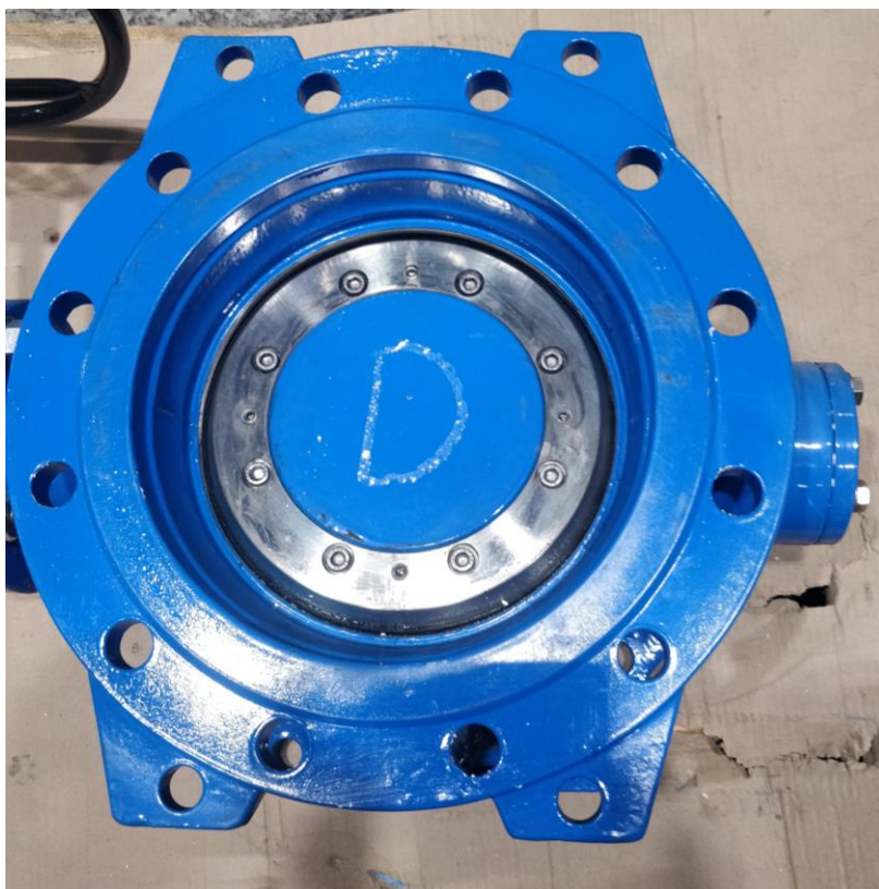
Slika 30. Primjer označavanja ispitanog i ispravnog komada
