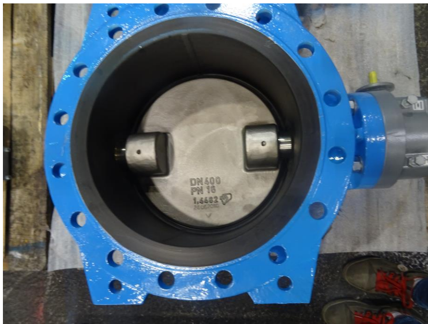
Slika 20. Leptirasti zatvarač DN 400 PN 16
