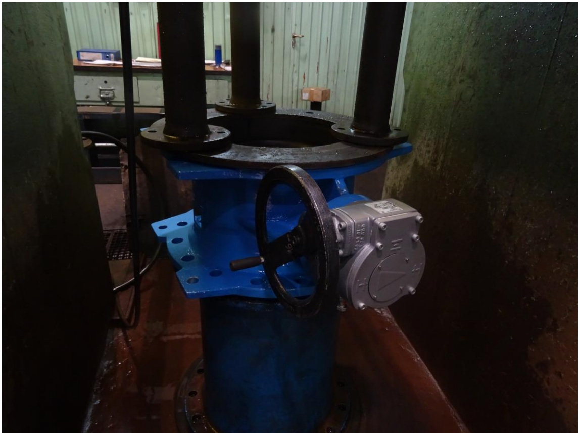
Slika 24. Ispitivanje proizvoda na nepropusnost dosjeda
