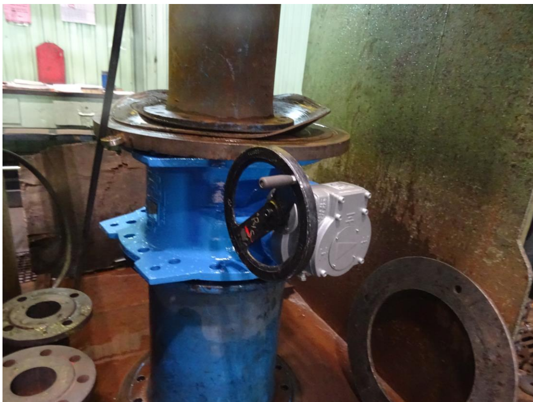
Slika 22. Postavljanje proizvoda na ispitno mjesto (pk 1)
