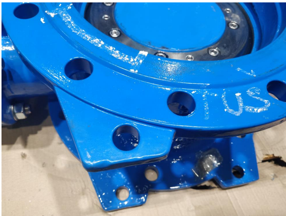
Slika 28. Primjer oznake greške tuš na segmentima propusnosti
