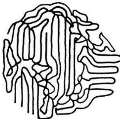
Slika 1.2.6.2. Polukristalni polimer (amorfna i kristalna struktura) [2]
