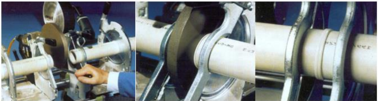
Slika 3.4.2. Zavarivanje cijevi vrućim alatom [19]
