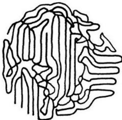
Slika 1.2.6.2. Polukristalni polimer (amorfna i kristalna struktura) [2]
