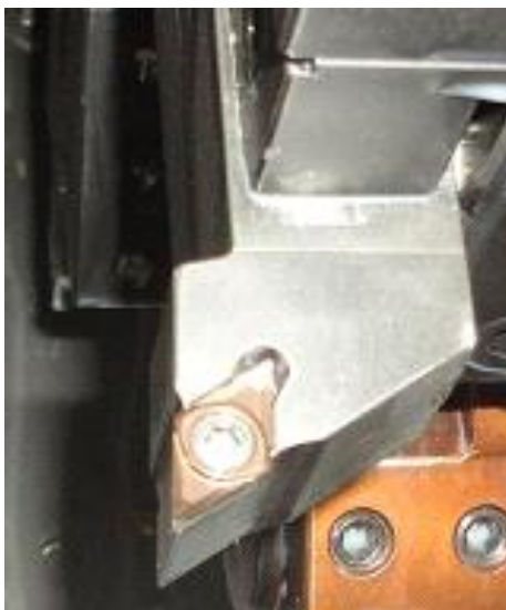
Slika 6.9. Nož za tokarenje s pločicom za fino vanjsko tokarenje [15]
