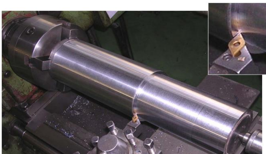
Slika 3.2. Uzdužno vanjsko tokarenje [8]
