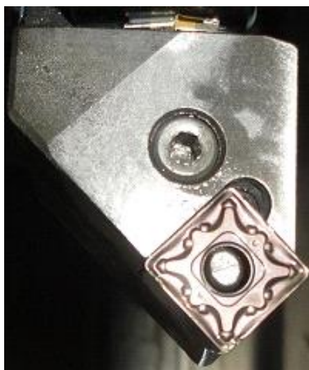
Slika 6.20. Nož za tokarenje s pločicom za plansko tokarenje [15]
