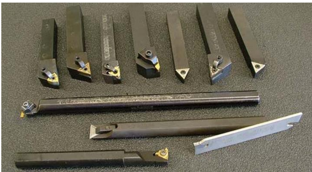
Slika 3.8. Prikaz različitih varijanti tokarskih noževa [10]
