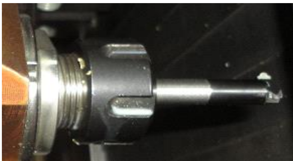
Slika 6.24. Glodalo za izradu navoja u gonjenom prihvatu [15]
