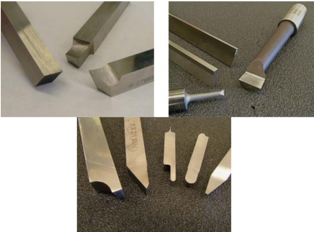
Slika 4.9. Alat od brzoreznog čelika [10]
