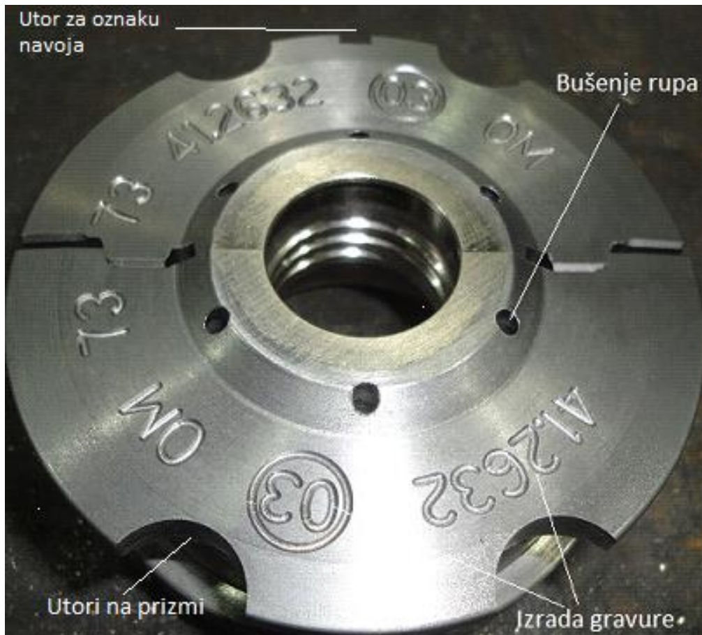
Slika 6.29. Bušenje rupa, graviranje, glodanje utora [15]
