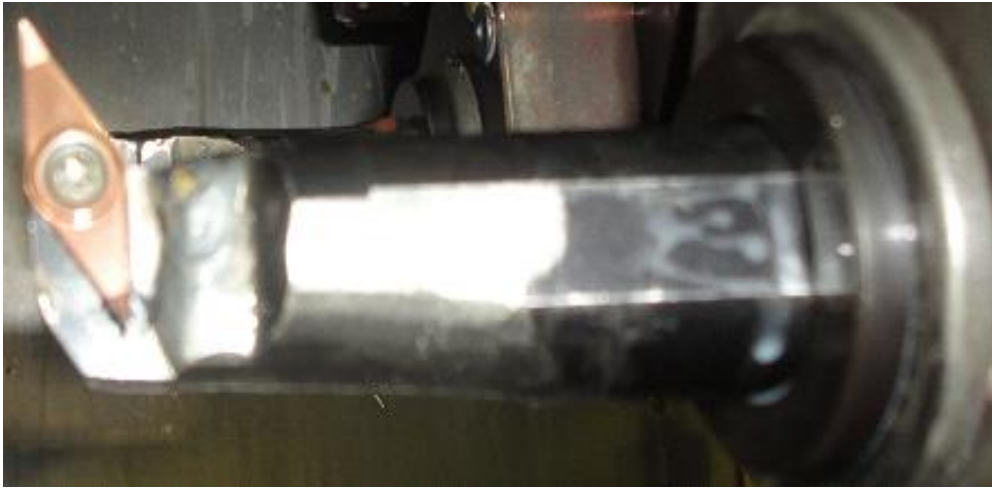
Slika 6.13. Nož za tokarenje sa pločicom za fino unutarnje tokarenje [15]
