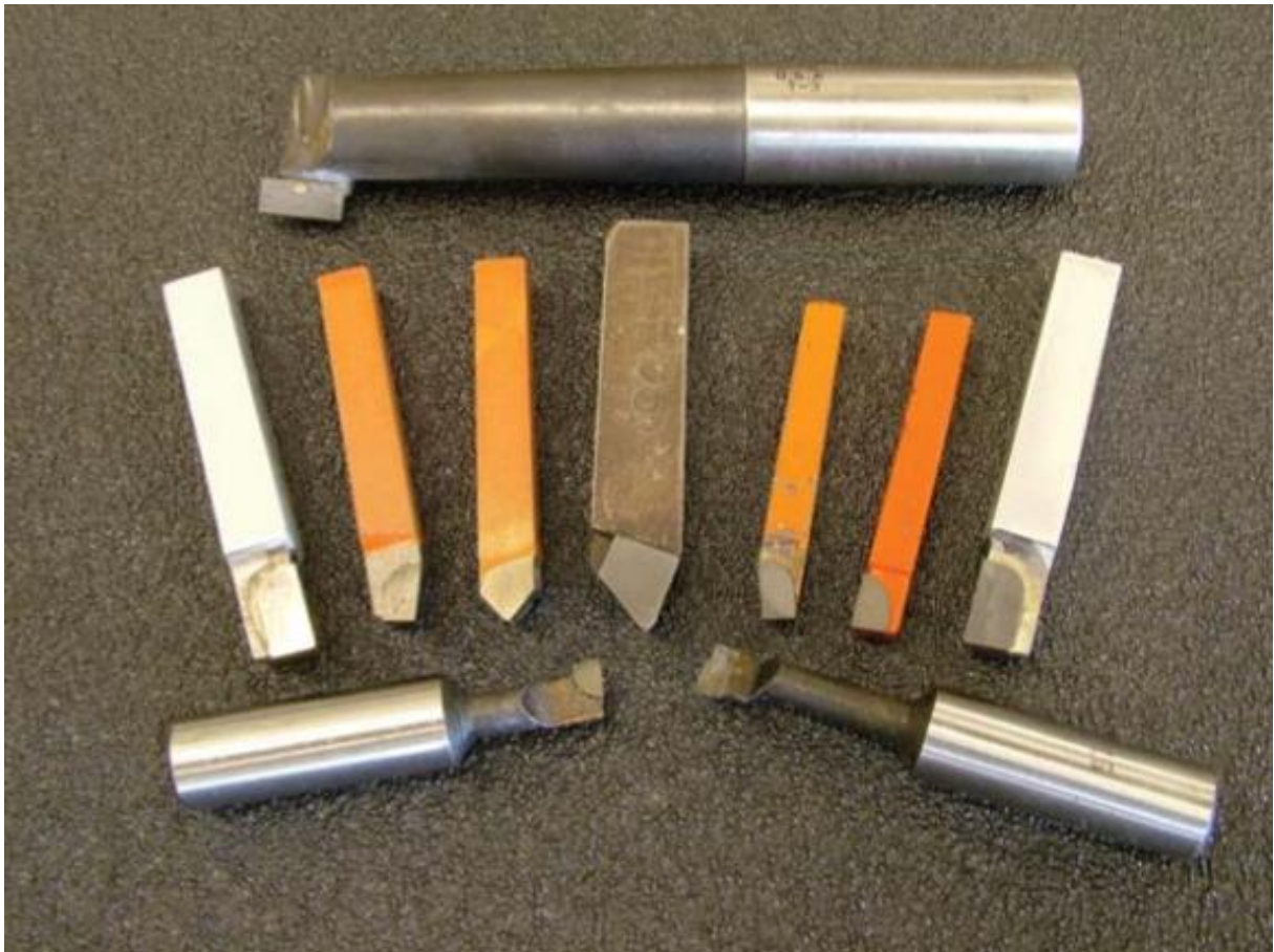
Slika 4.10. Alat od tvrdog metala [10]
