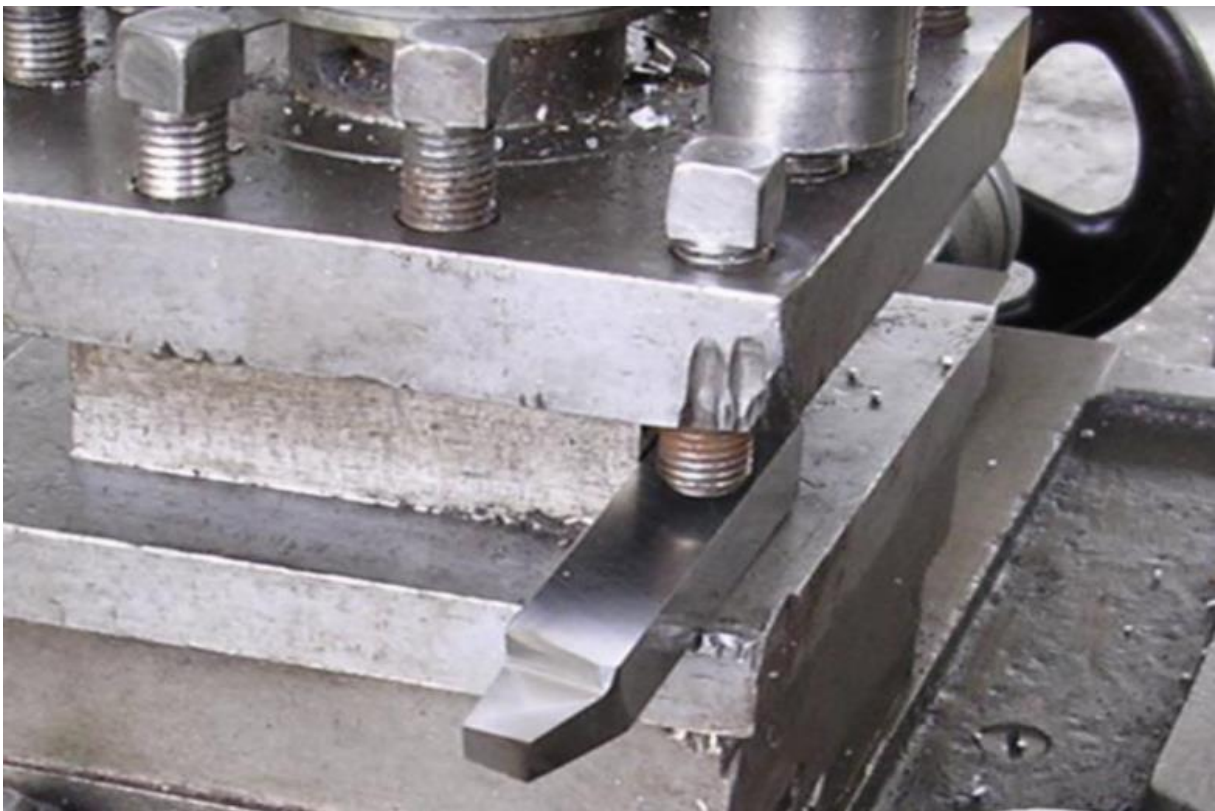
Slika 3.10. Tokarski nož iz brzoreznog čelika [6]
