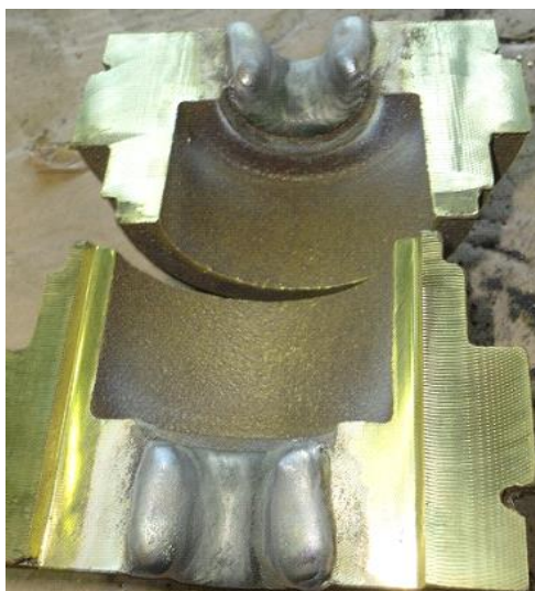
Slika 6.3. Izgled navarenog komada [15]
