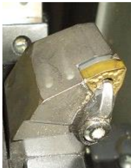
Slika 6.17. Nož za tokarenje s pločicom za grubo vanjsko tokarenje (TRIGON) [15]
