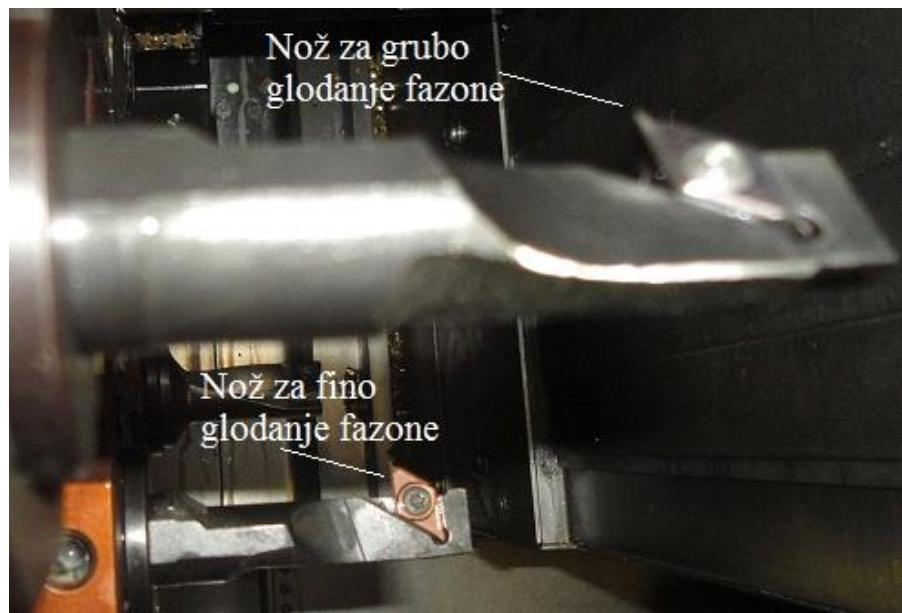
Slika 6.22. Nož za tokarenje s pločicom za fino unutarnje tokarenje faze [15]
