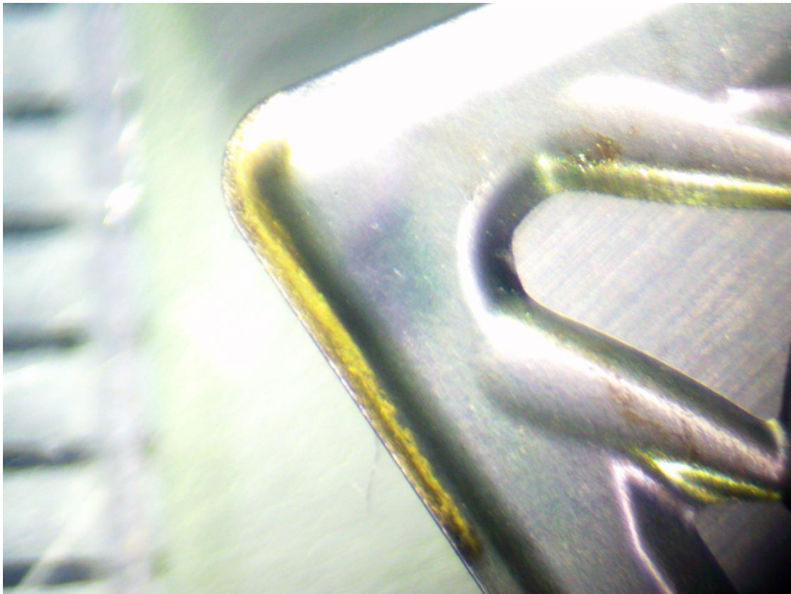
Slika 7.17. Prikaz istroženosti pločice po duljini rezne oštrice za slučaj II-3. [17]
