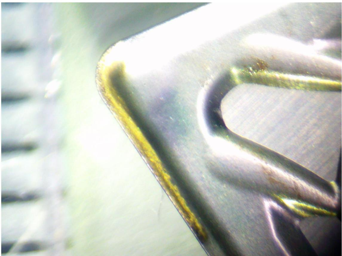
Slika 7.17. Prikaz istrošenosti pločice po duljini rezne oštice za slučaj II-3. [17]
