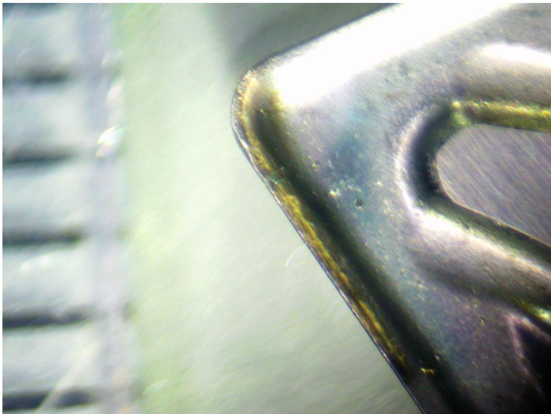
Slika 7.15. Prikaz istrošenosti pločice po duljini rezne oštice za slučaj II-2. [17]
