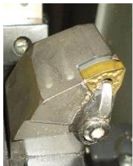
Slika 6.17. Nož za tokarenje s pločicom za grubo vanjsko tokarenje (TRIGON) [15]
