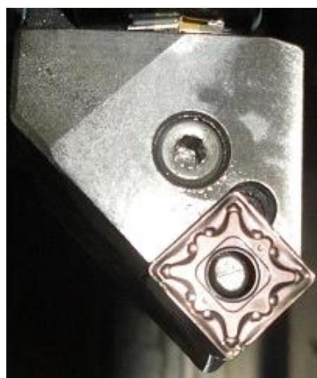
Slika 6.20. Nož za tokarenje s pločicom za plansko tokarenje [15]
