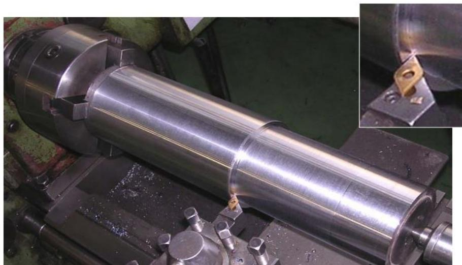
Slika 3.2. Uzdužno vanjsko tokarenje [8]
