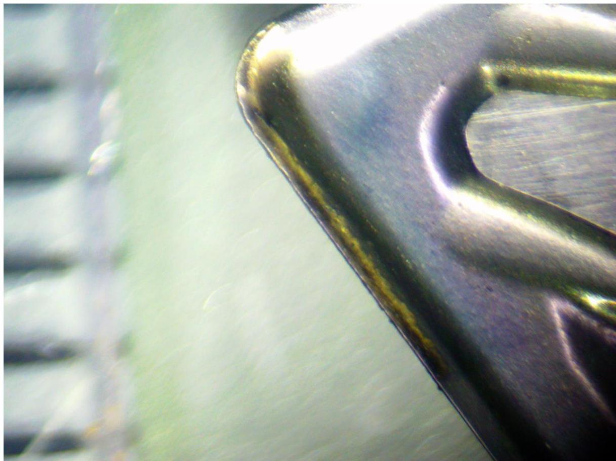
Slika 7.7. Prikaz istrošenosti pločice po duljini rezne oštice za slučaj I-1. [17]
