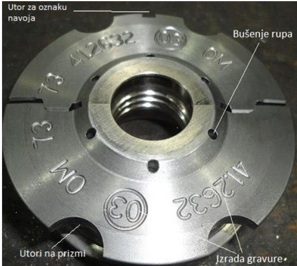
Slika 6.29. Bušenje rupa, graviranje, glodanje utora [15]
