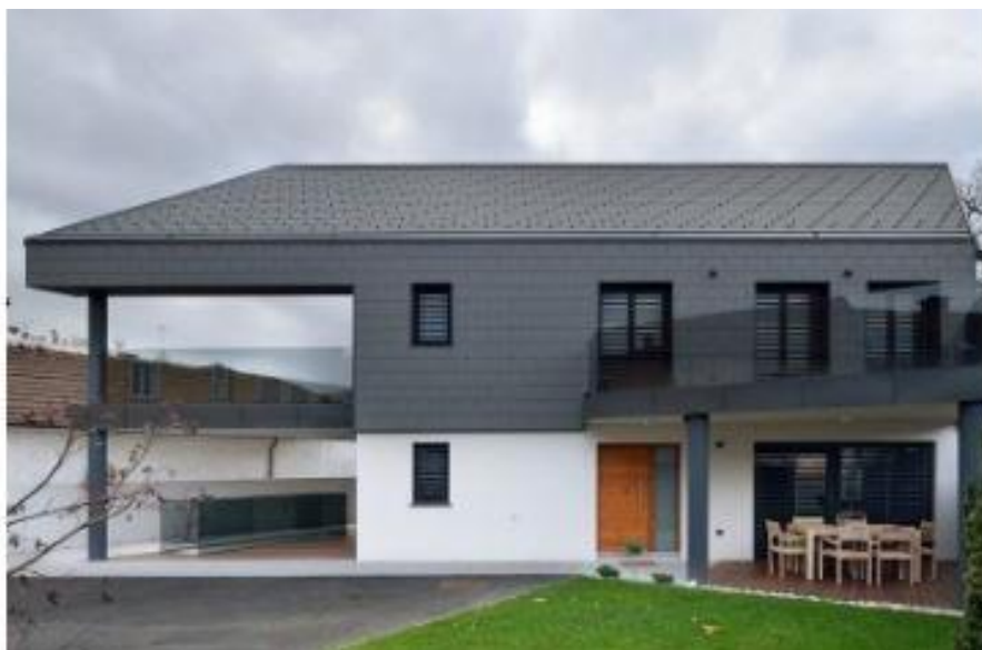
Slika 3.20 Pokrov od maloformatnih vlakno-cementnih ploča
