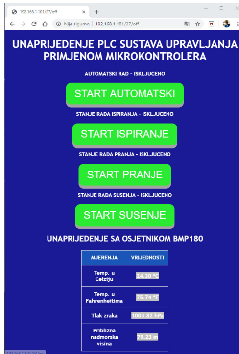
Slika 3.13 Prikaz ažuriranog sučelja unaprijeđenog osjetnikom BMP180
