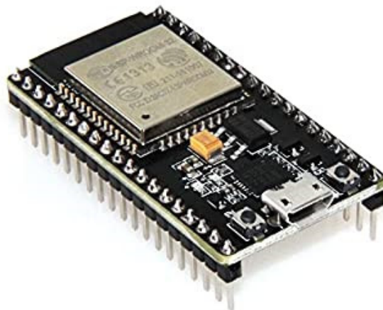
Slika 3.2 Prikaz ESP32 mikrokontrolera [12]
