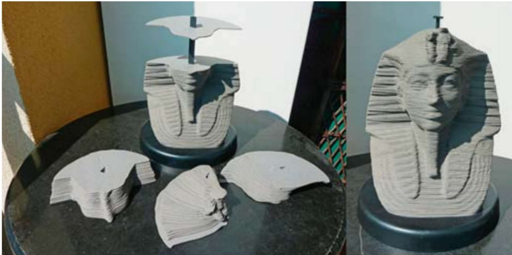
Slika 3. Načelo aditivne proizvodnje [18]
