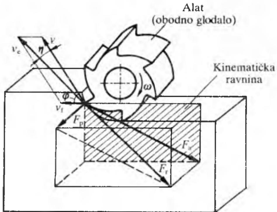
Slika 2. Sile rezanja protusmjernom obodnom glodanju [20]
