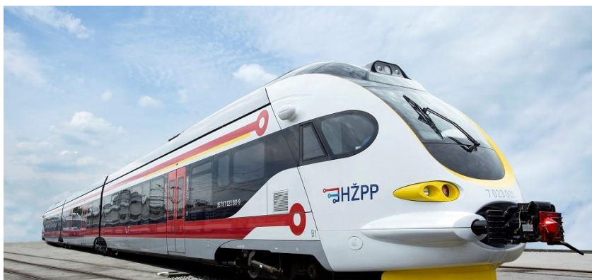
Slika 11. Niskopodni dizel-motorni vlak serije 7 023
