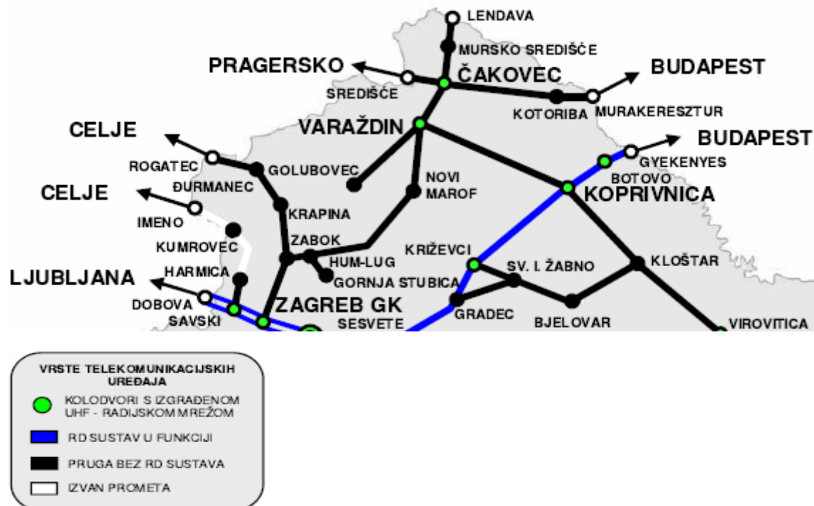
Slika 8. Vrste telekomunikacijskih uređaja željezničkih kolodvora u RH, pruga R202 Varaždin-Dalj, kolodvor Varaždin i Koprivnica
