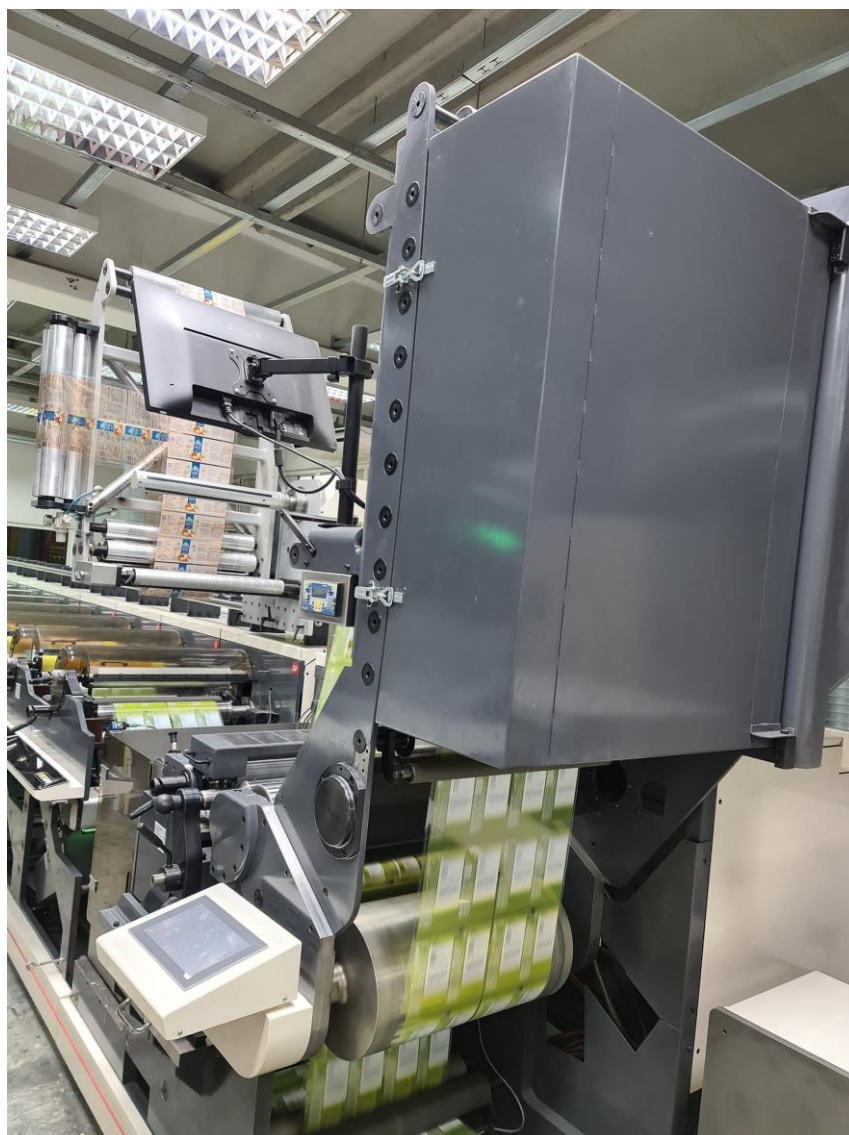
Slika 4.8 Agregat za specijalne nanose
