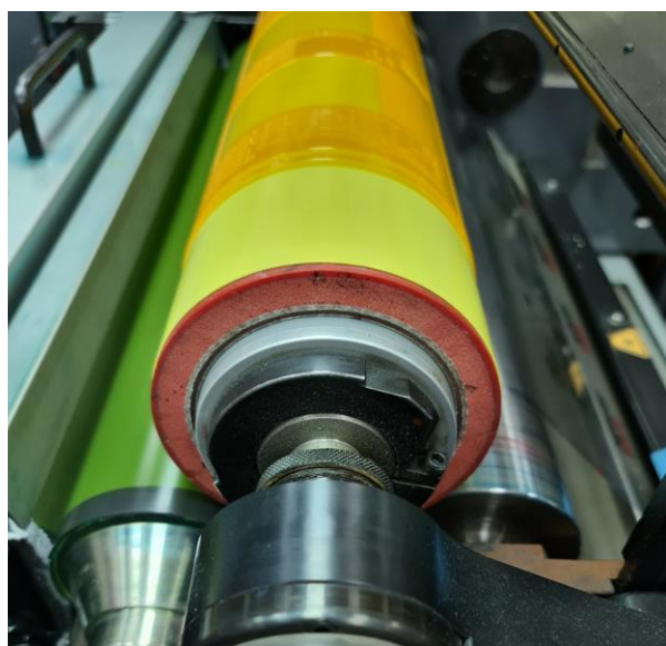
Slika 2.19 Točke pritiska tiska
