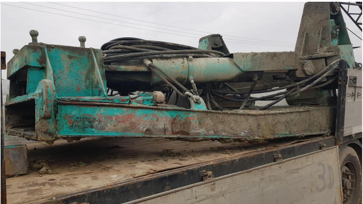
*Slika 4.1.12-3 Hidraulički oscilator*
