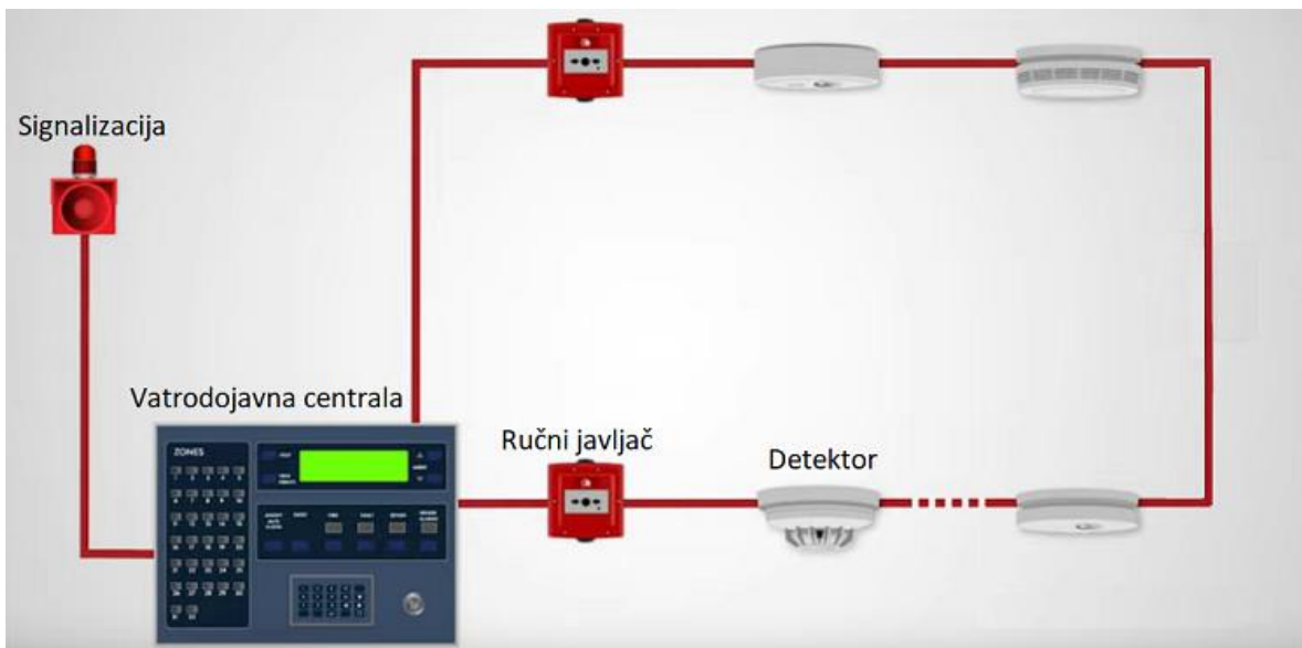
Slika 5.2 Primjer vatrodojavnog sustava
