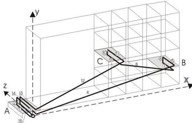
Slika 3.16 Prikaz kretanja S/R robota u dvostrukom ciklusu [6]
