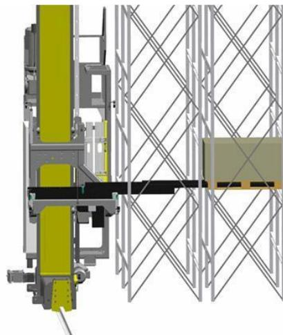
*Slika 3.10 Stupni roboti s teleskopskim vilicama u regalima dvostrukе dubine [8]*
