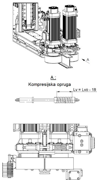
Slika 4.17 Prikaz pogona robota [2]
