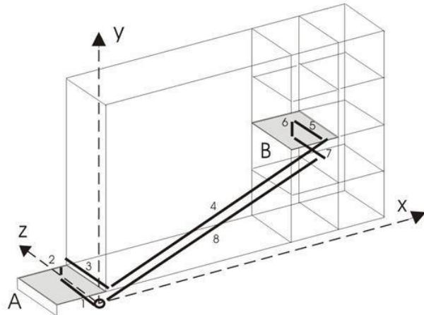
Slika 3.15 Prikaz kretanja S/R robota u jednostrukom ciklusu [6]
