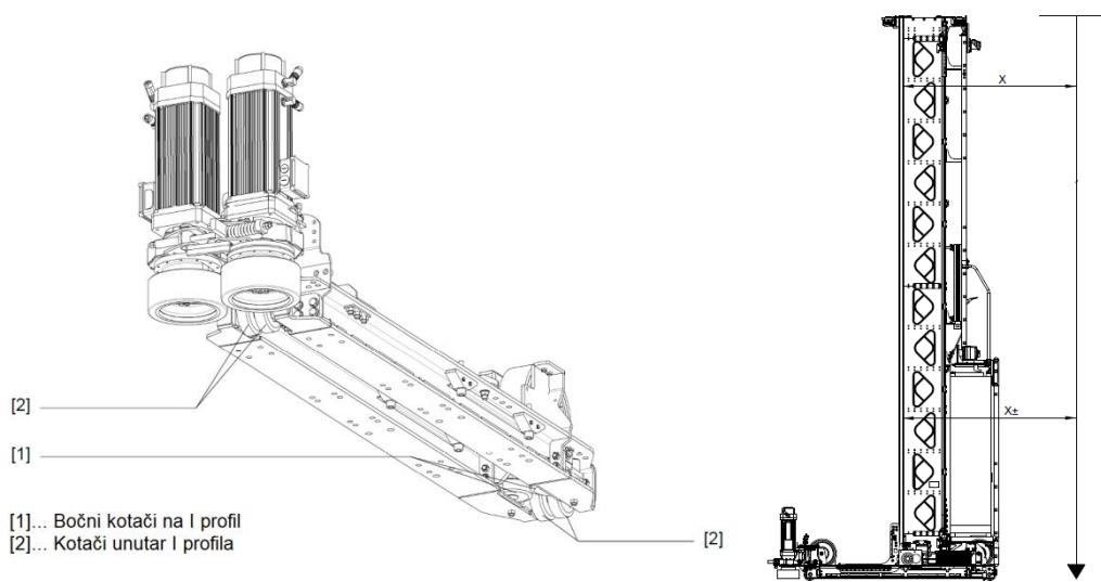
Slika 4.16 Točke podešavanja za okomitost jarbola na podvozje [2]
