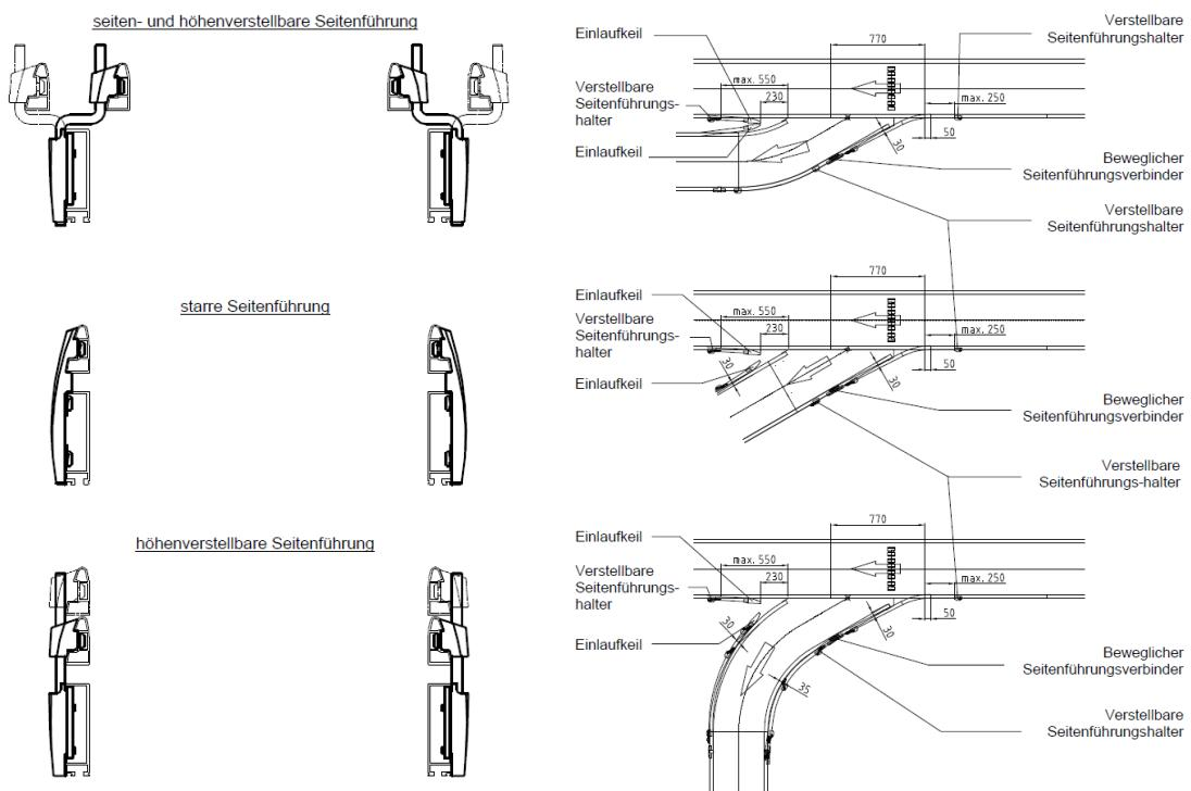
Slika 4.11 Standardni primjer i izgled bočnih vodilica [2]
