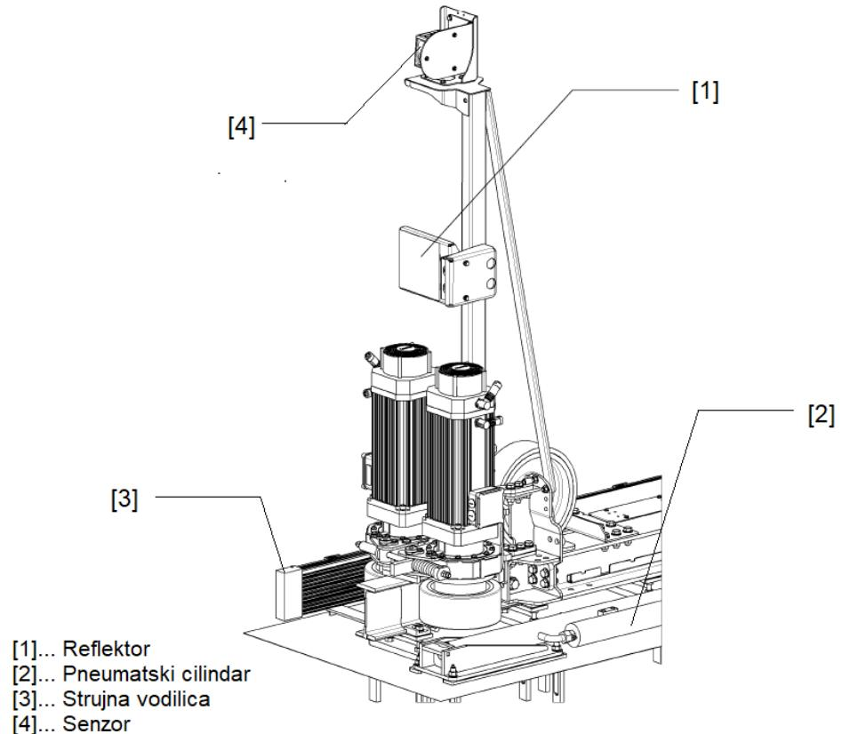
*Slika 4.19 Dijelovi robota za orijentaciju i sigurnost [2]*
