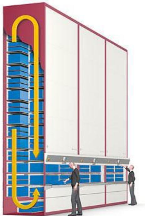
Slika 3.3 Vertikalni karusel [6]
