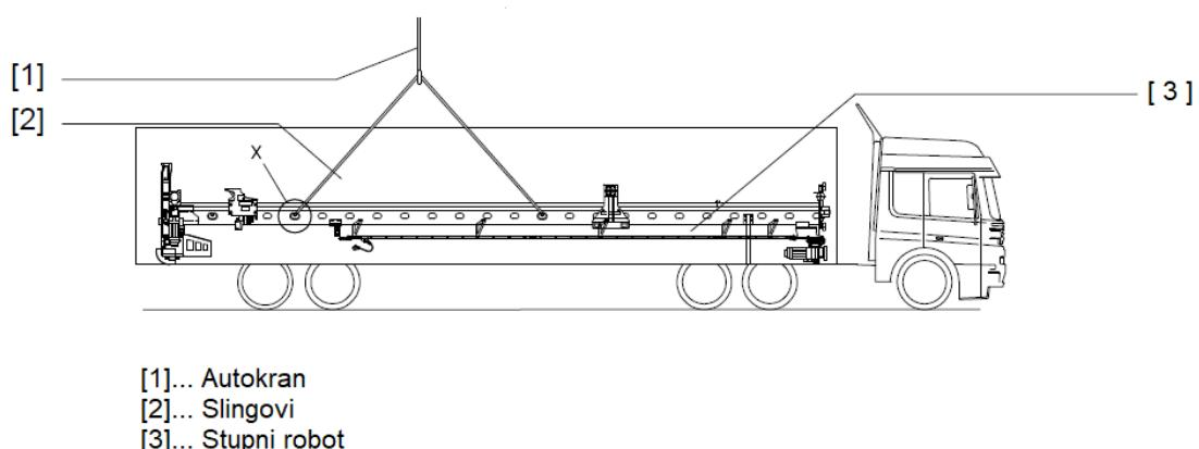
Slika 4.13 Istovar robota [2]
