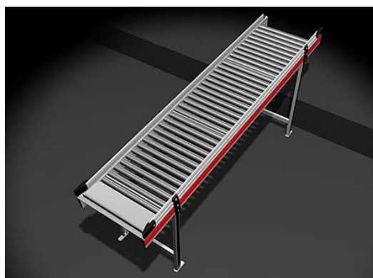
Slika 2.6 Transportna traka s metalnim valjcima [2]
