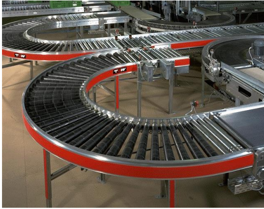
Slika 2.9 Pokretna traka sa konusnim valjcima za 180 stupnjeva [2]
