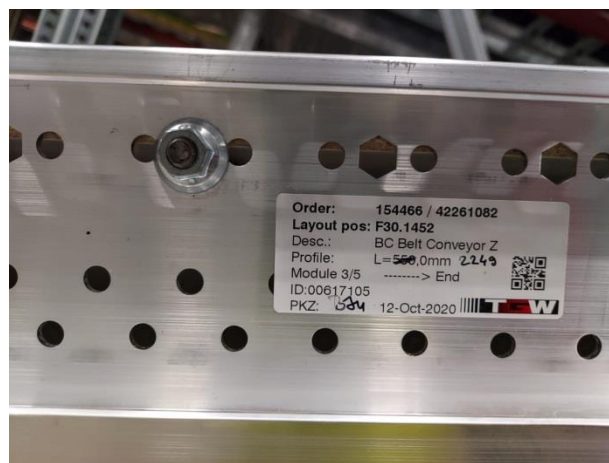
Slika 4.3 Prikaz oznake pozicije, smjera i broj elemenata u nizu [2]
