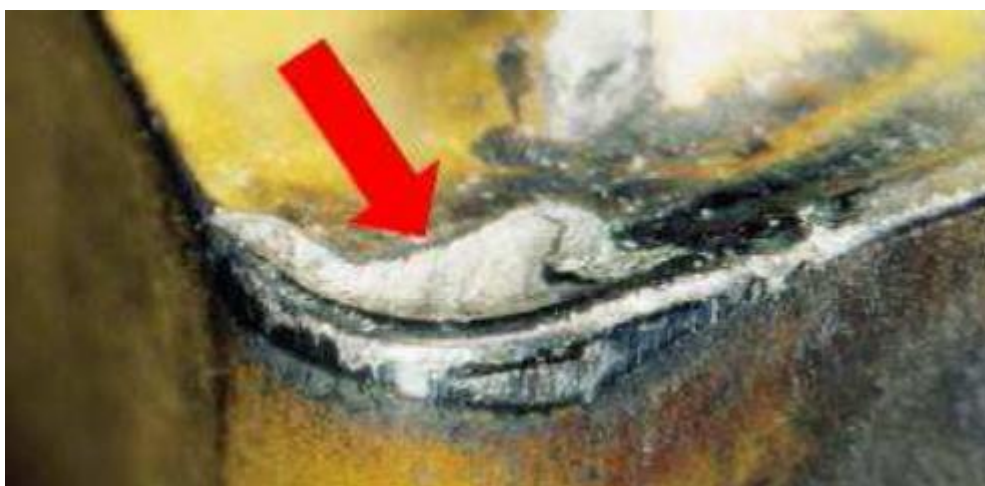
Slika 10. Krater na reznoj pločici [2]
