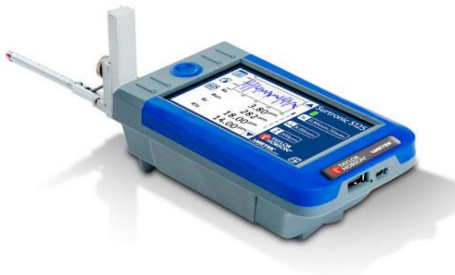
Slika 44. Uređaj za mjerenje hrapavosti
