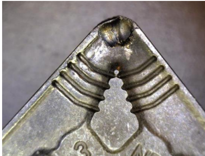
Slika 25. Trošenje gdje se stvara krater [21]
