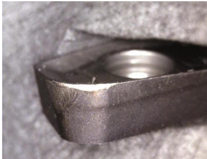
Slika 28. Trošenje radijusa nosa [21]
