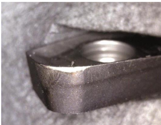
Slika 28. Trošenje radijusa nosa [21]
