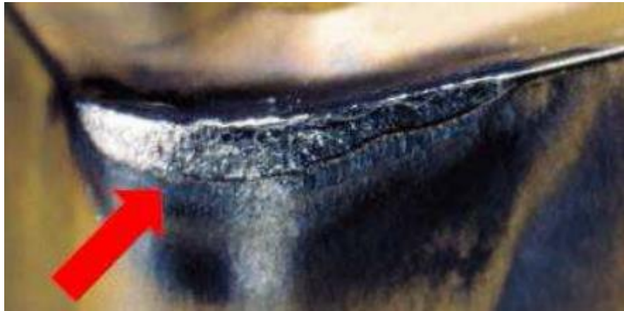
Slika 9. Trošenje na stražnjoj površini alata [2]
