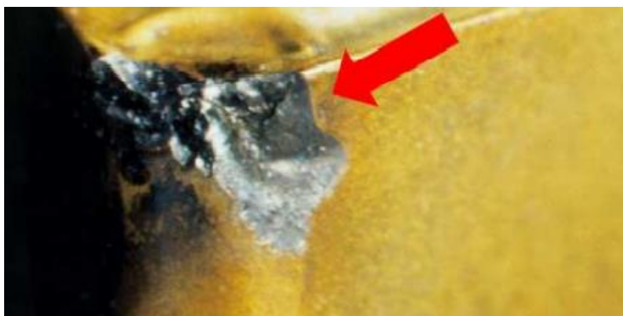
Slika 14. Lom rezne oštrice [2]
