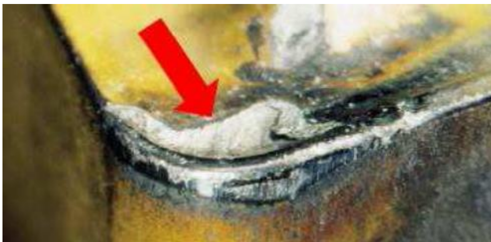
Slika 10. Krater na reznoj pločici [2]
