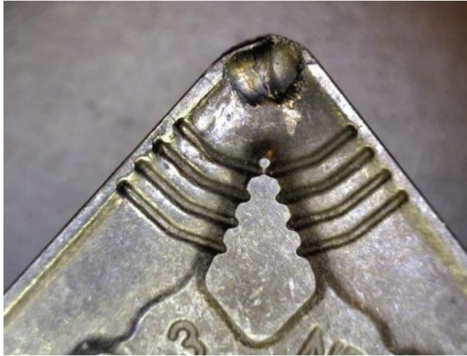
Slika 25. Trošenje gdje se stvara krater [21]
