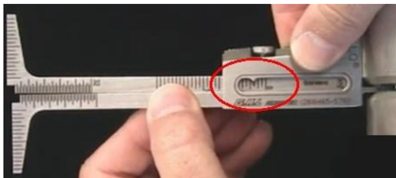
Slika 4.6. prikaz očitavanja debljine stijenke
