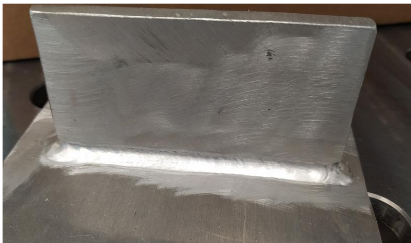
Slika 5.1. Prikaz kutnog spoja AlMg5 izvedenog TIG postupkom
