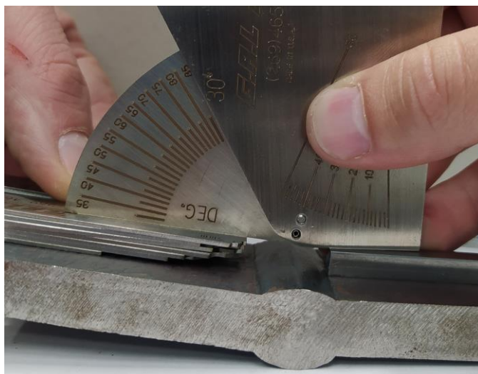
Slika 5.9. Prikaz mjerenja odstupanja od dimenzija i oblika
