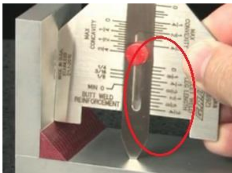
Slika 4.19. Prikaz mjerenja i očitavanja vrijednosti visine kraka kutne izvedbe spoja
