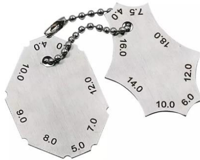
Slika 4.3 Šablone kod kontrole kutnih zavara [8]
