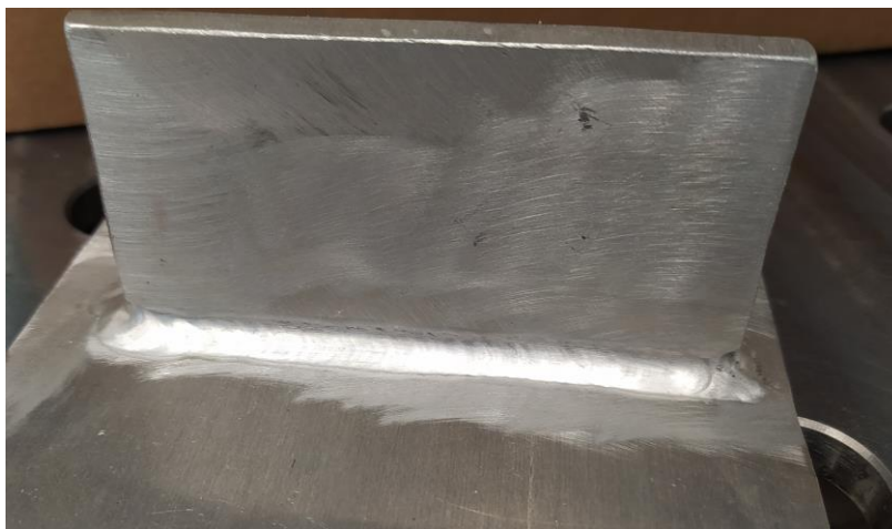
Slika 5.1. Prikaz kutnog spoja AlMg5 izvedenog TIG postupkom
