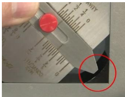
Slika 4.20 Prikaz mjerenja i kontrole dimenzija konkavnog zavarenog spoja u kutnoj izvedbi
