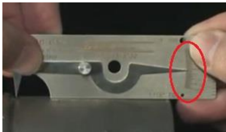
Slika 4.15. Mjerenje ugorina ili udubljenja v-wac
