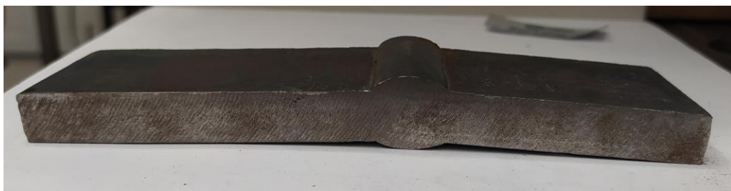
Slika 5.8. Prikaz sučeonog spoja i odstupanja od dimenzija i oblika izvornog spoja
