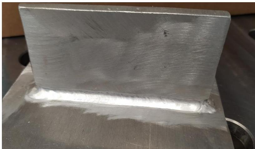
Slika 5.1. Prikaz kutnog spoja AlMg5 izvedenog TIG postupkom
