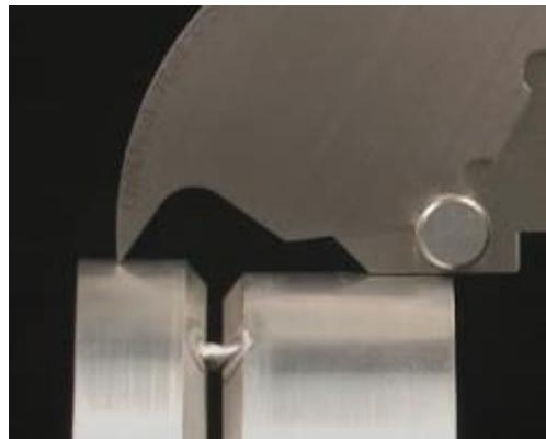
Slika 4.11. Prikaz mjerenja linearног odstupanja vanjske stijenke cijevi
