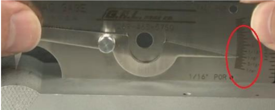
Slika 4.14. prikaz mjerenja nadvišenja v-wac mjerilom
