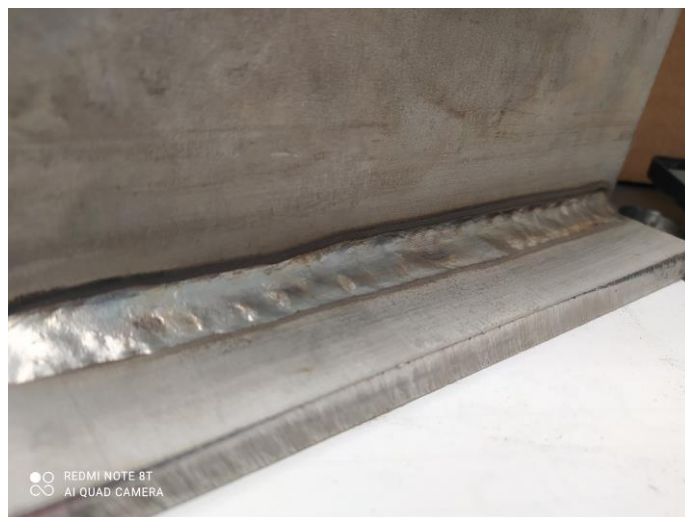
Slika 5.5. Kutni spoj čeličnih ploča X5CrNiMo 17-12-2
