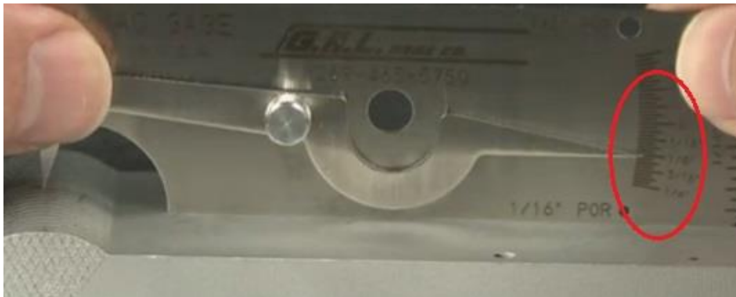
Slika 4.14. prikaz mjerenja nadvišenja v-wac mjerilom
