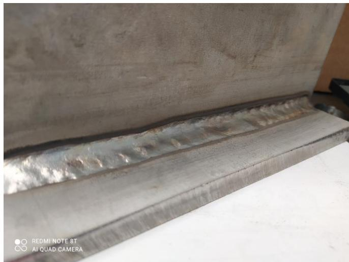
Slika 5.5. Kutni spoj čeličnih ploča X5CrNiMo 17-12-2
