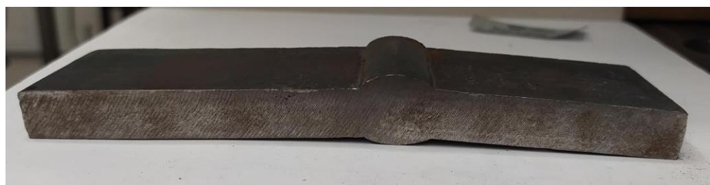
*Slika 5.8. Prikaz sučevnog spoja i odstupanja od dimenzija i oblika izvornog spoja*
