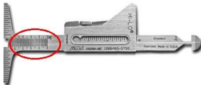
Slika 4.4. Prikaz očitavanja skale za nadvišenje zavara
