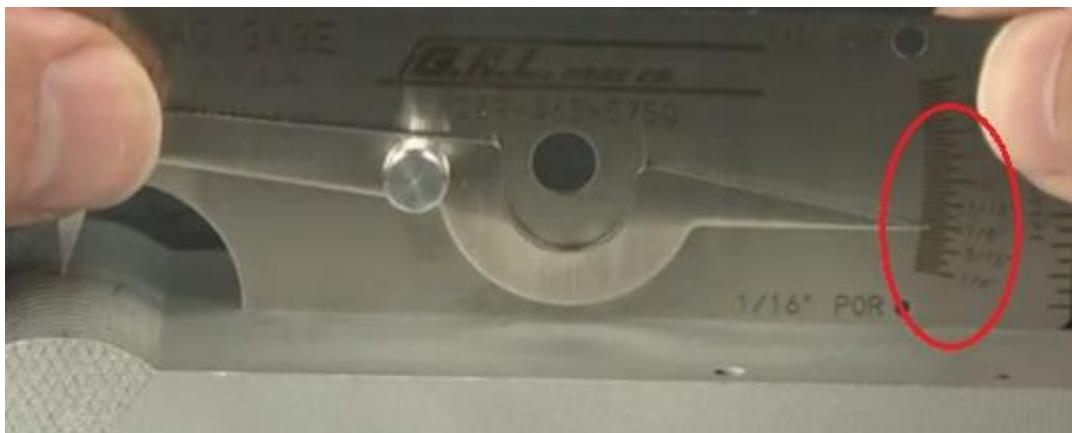
*Slika 4.14. prikaz mjerjenja nadvišenja v-wac mjerilom*
