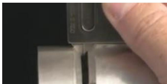
Slika 4.7. mjerene skošenje pripremnog žlijeba
