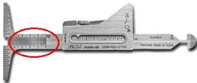
Slika 4.4. Prikaz očitanja skale za nadvišenje zavara
