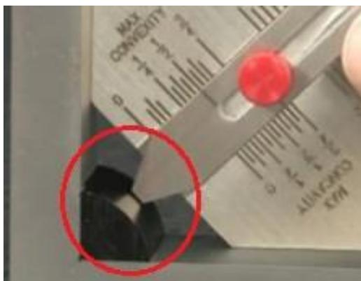
*Slika 4.21 Prikaz mjerena nadvišenja (konveksnosti) zavarenog spoja u kutnoj izvedbi*
