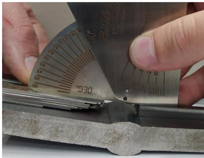
Slika 5.9. Prikaz mjerena odstupanja od dimenzija i oblika
