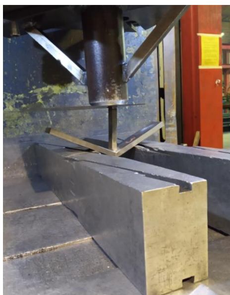
Slika 40. Opterećivanje uzoraka nožem za savijanje na hidrauličkoj preši
