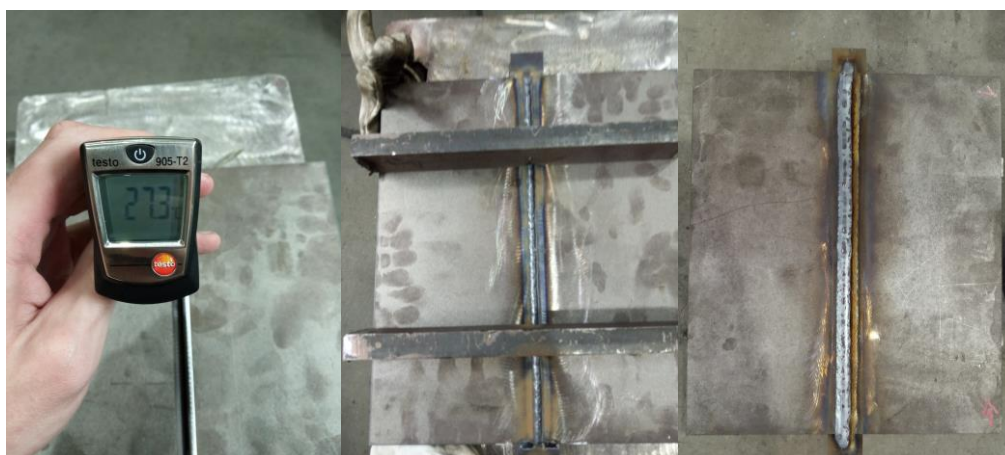
Slika 24. Kontrola uzorka 1 prije, tijekom i nakon zavarivanja
