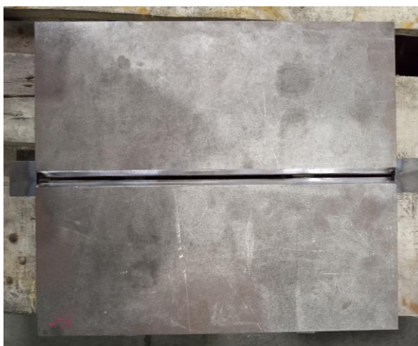
Slika 23. Pripremljene ploče zavarivanog uzorka sučeljenog spoja
