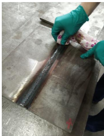
Slika 27. Čišćenje površine prije ispitivanja tekućim penetrantima
