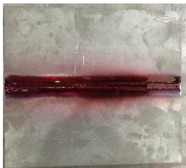
Slika 30. Nanesen crveni penetrant na površinu zavarenog spoja
