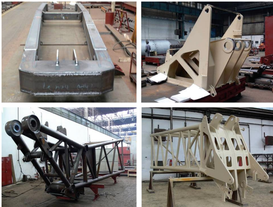
Slika 18. Dijelovi konstrukcija od S690QL u zavarenoj izvedbi u proizvodnji [18]
