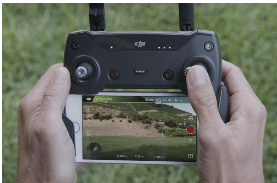
Slika 4.3 Primjer jednostavnog sustava za upravljanje dronom
