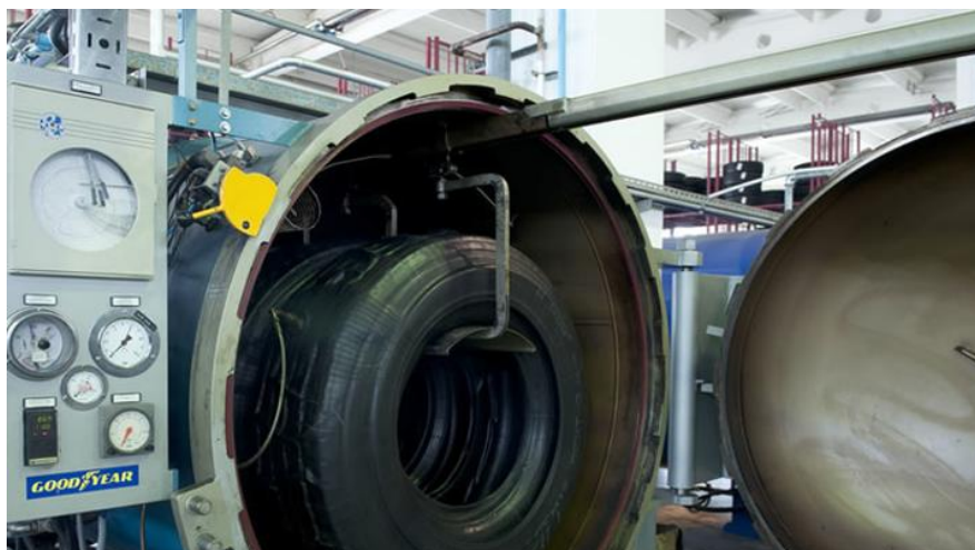
Slika 9. Postupak obnavljanja gume u poduzeću Gumiimpex – GRP
