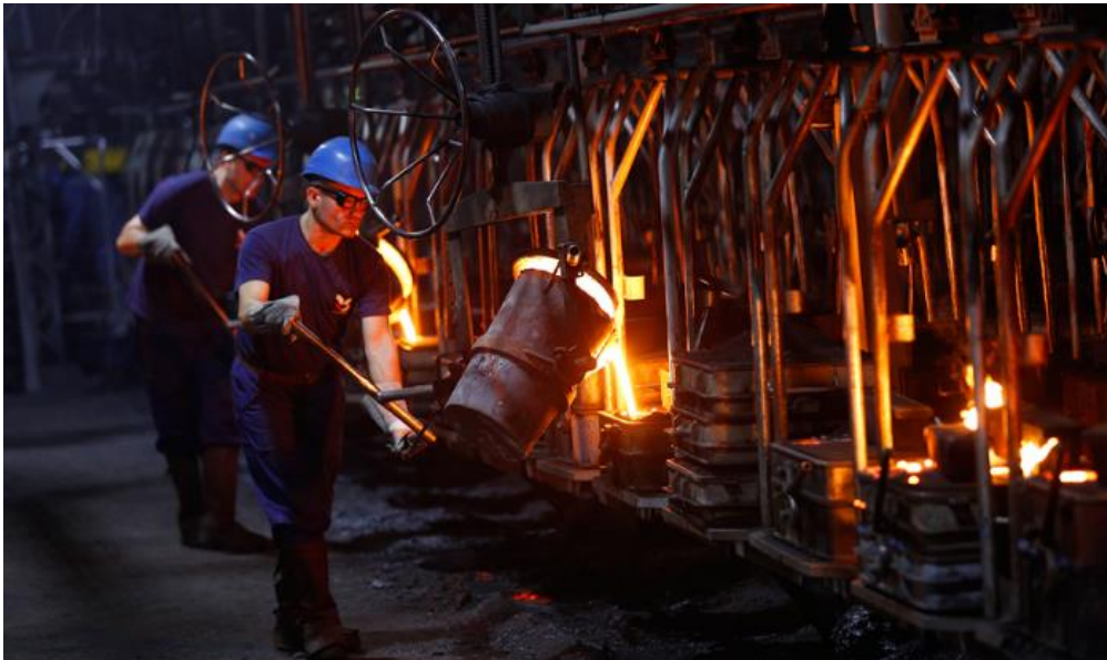
Slika 19. Postupak lijevanja, izvor: https://www.rsmetali.hr/rapid-virovitica.aspx
