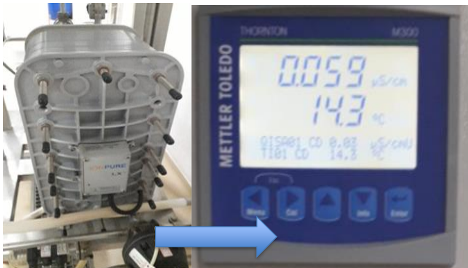
Slika 3.16. Modul kontinuirane deionizacije i transmiter vrijednosti pročišćene vode M300 (vlastiti izvor)
